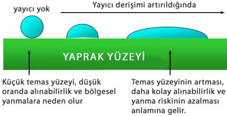
Şekil 2.2.1. Yayıcı ve yapıştırıcı derişiminin artmasına bağılı olarak elementlerin yaprak yüzeyine tutunması (Moran 2004).
