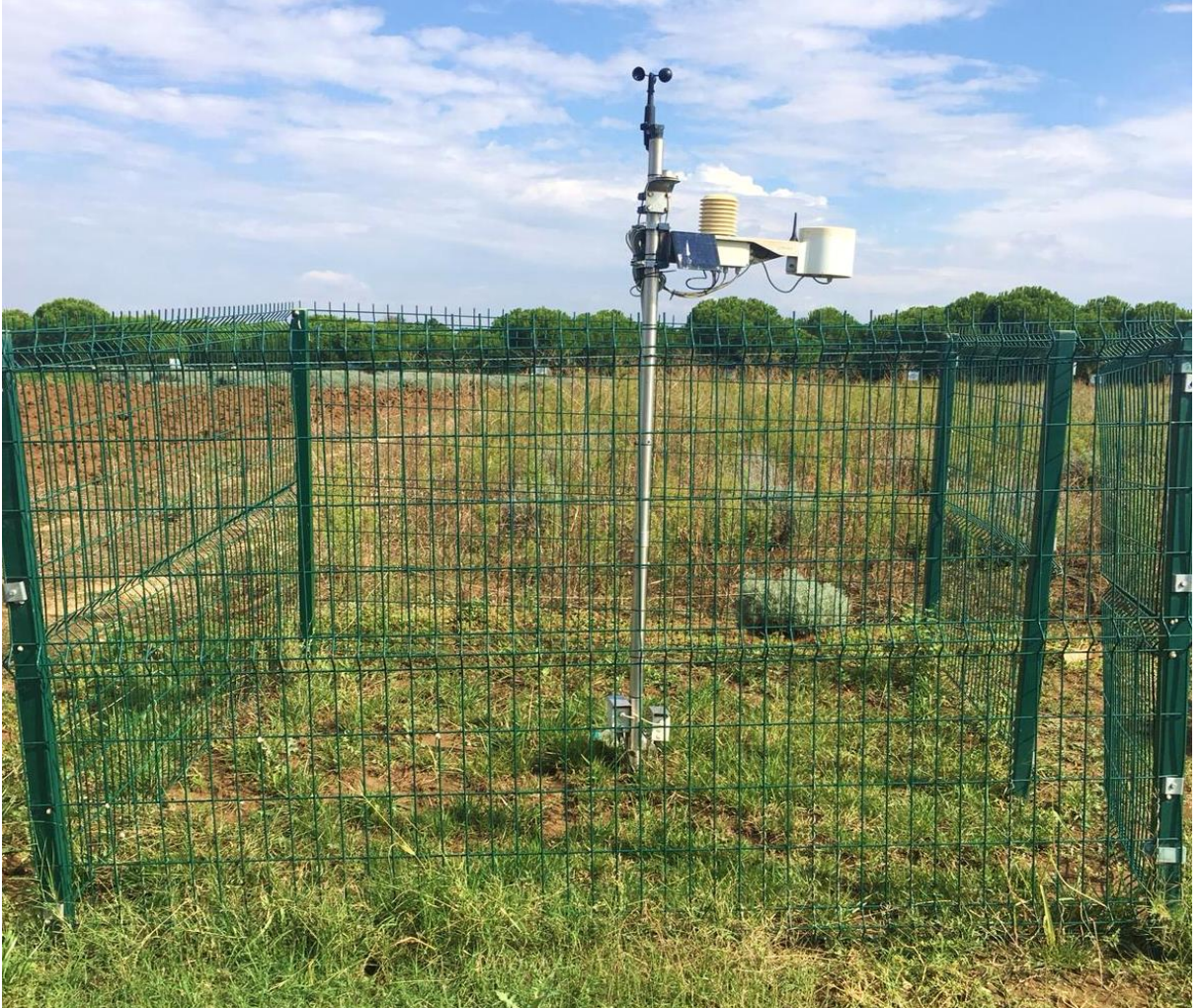
Şekil 3.3. Deneme alanında kullanılan otomatik meteoroloji istasyonu
