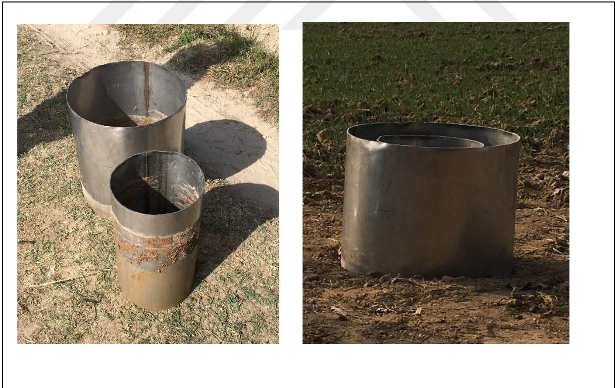
Şekil 3.2. Çift silindirli infiltrometre
