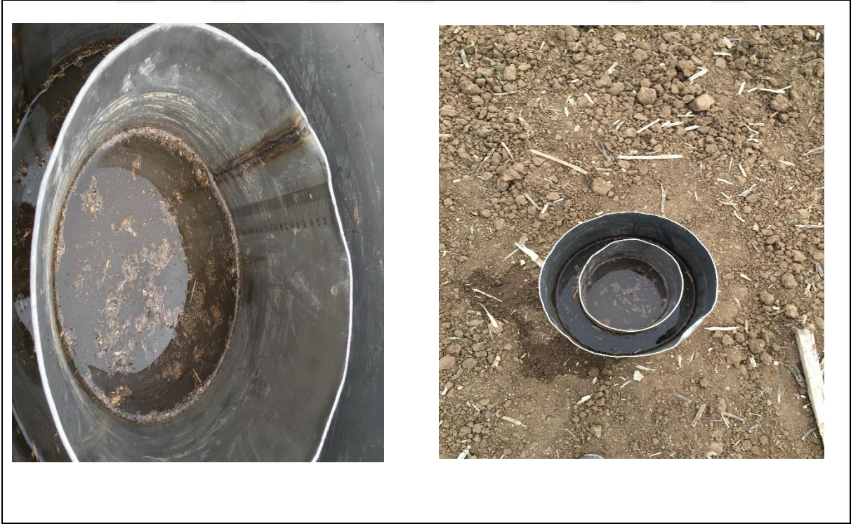
Şekil 3.4. Çift silindirli infiltrometre okumaları
