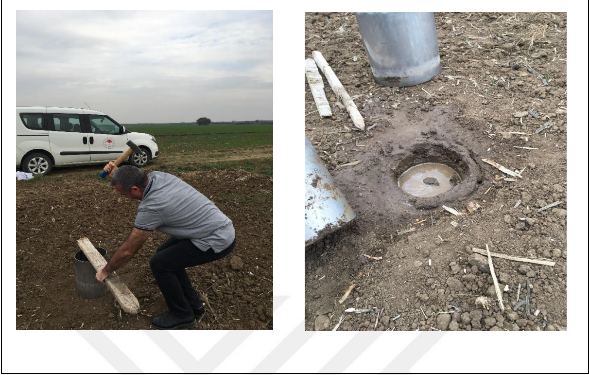
Şekil 3.3. İnfiltrometrenin ölçüm için hazırlanması
