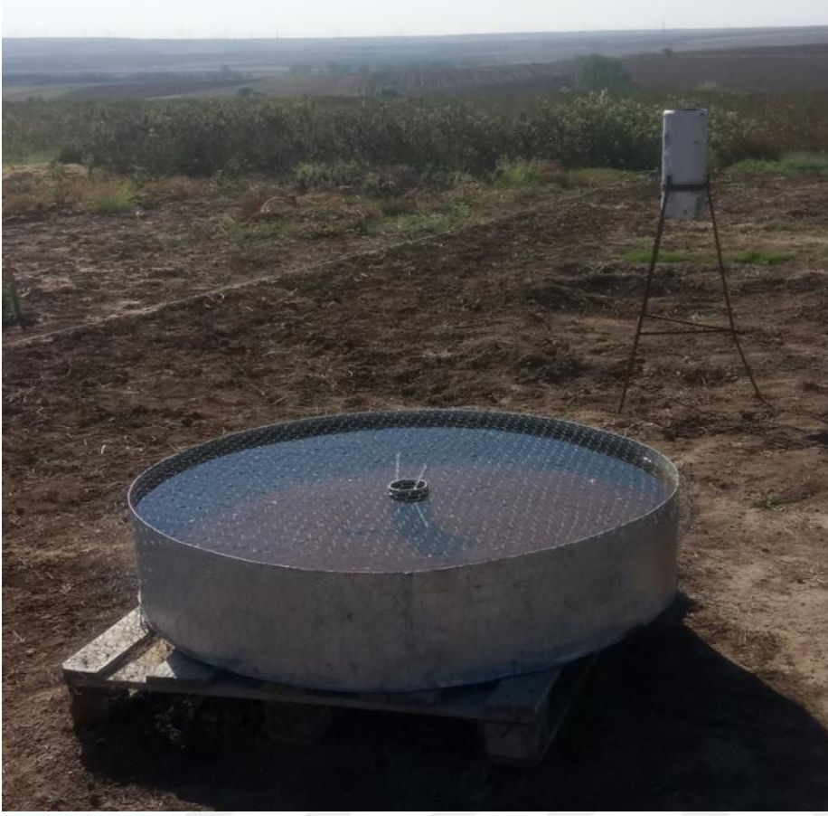
Şekil 3.8. A sınıfı buharlaşma kabı ve püliviyometre
