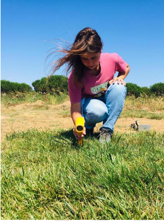
Şekil 3.10. İnfrared termometre ile bitki yüzey sıcaklığının ölçülmesi
