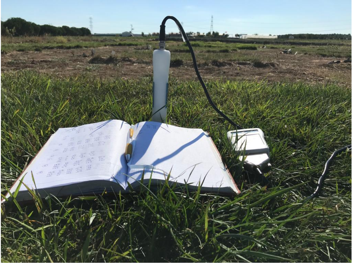
Şekil 3.6. Toprak nem ölçüm aracı (PR2 Probe ve HH2 Soil Moisture Meter, Delta-T Devices Ltd., Cambridge, UK)
