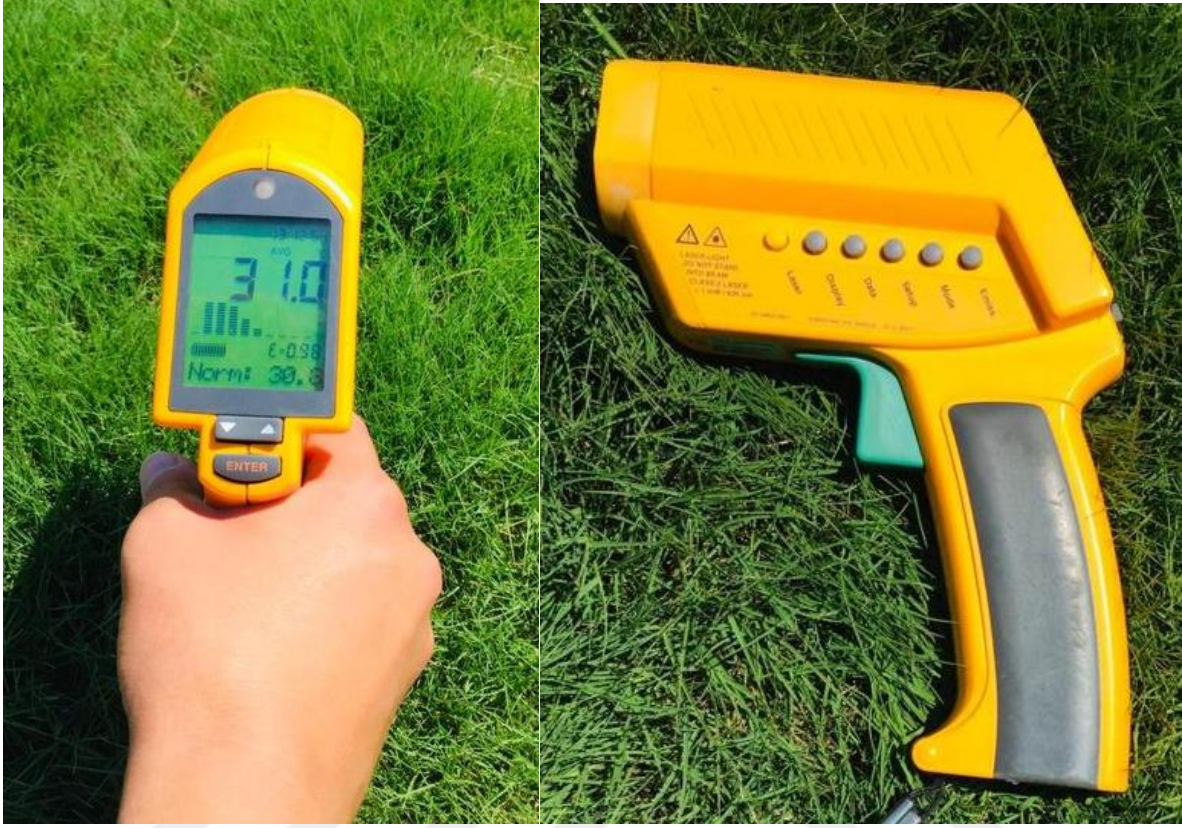
Şekil 3.9. Infrared (Kızılötesi) termometre
