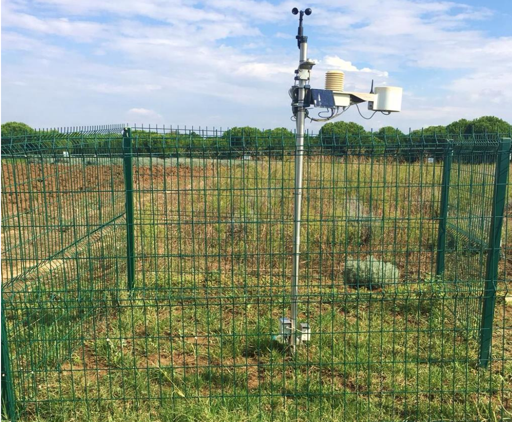
Şekil 3.3. Deneme alanında kullanılan otomatik meteoroloji istasyonu
