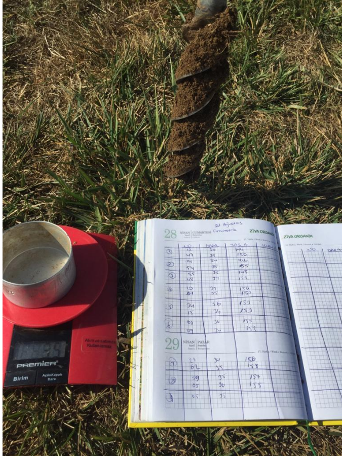
Şekil 3.13. Gravimetrik yöntem ile toprak nem ölçümü
