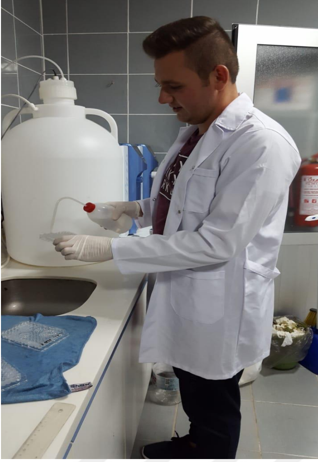
Şekil 3.3 DAS-ELISA testinde ELISA platelerinin yıkanması işlemi
