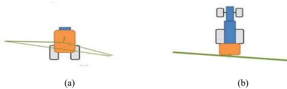
Şekil 3.5. İki eksendeki bum hareketleri. (a) Yuvarlanma (Roll) momenti (b) Savrulma (Yaw) momenti (Bjornsonn vd. 2013).
