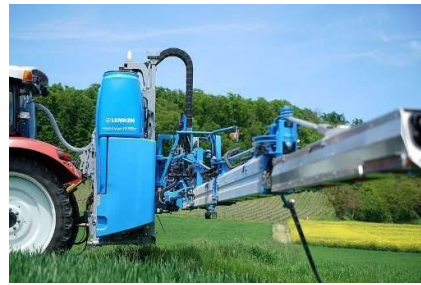
Şekil 3.9. İlaçlama Memelerinin Kanat Profili İçerisine Yerleştirildiği Tasarımlar (Anonim, 2021p)
