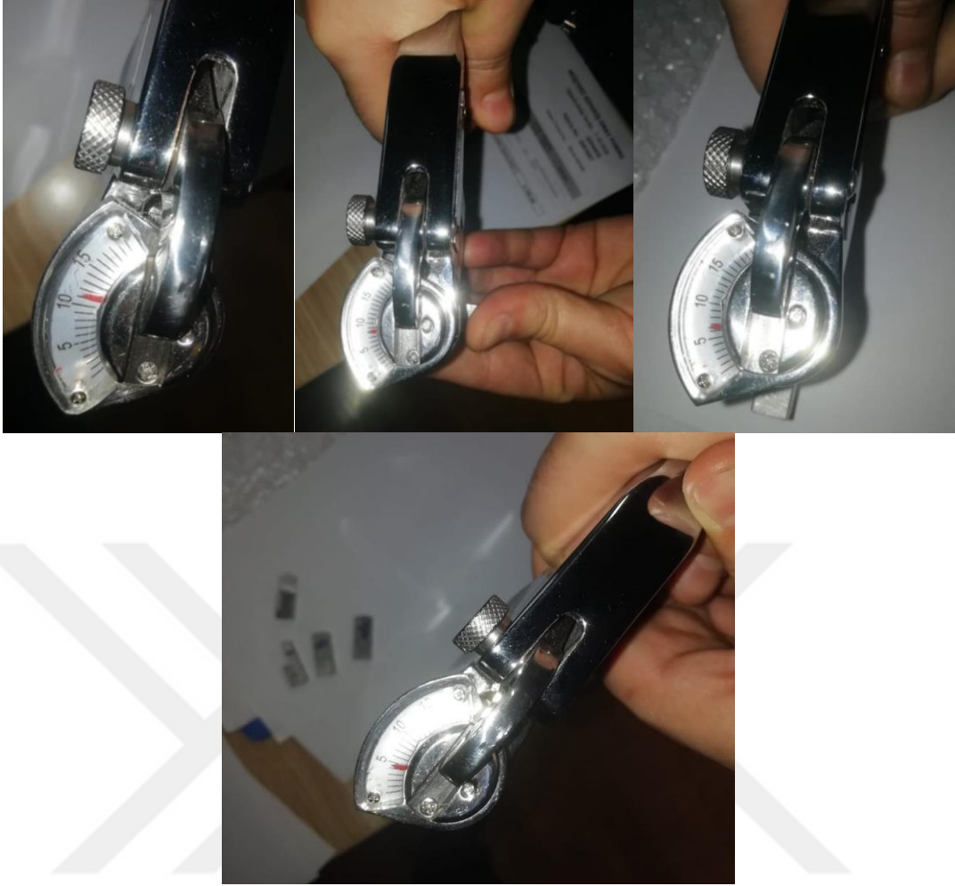
Şekil 5.5. Test numuneleri sertlik değerleri ölçümü
