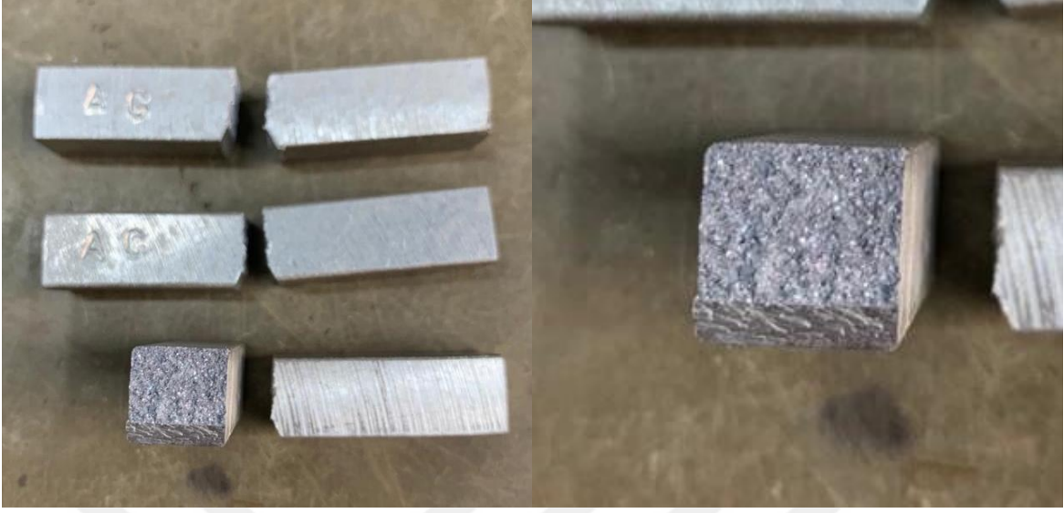
Şekil 6.6. Kırılmış charpy test numunesi görseli
