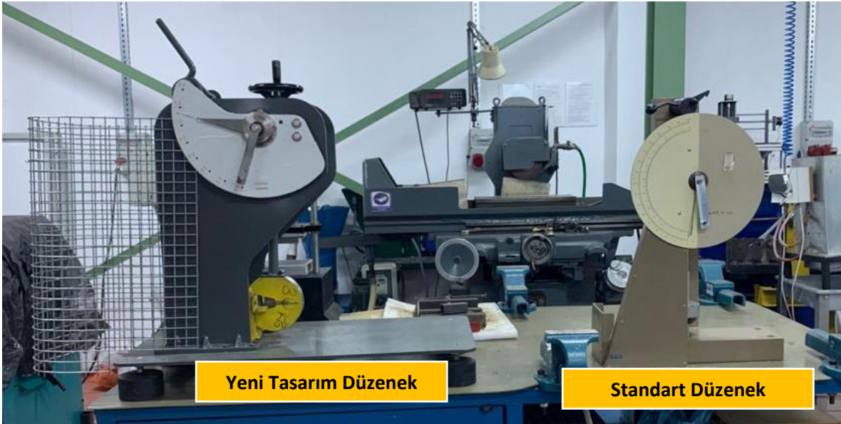
Şekil 6.1. Tez kapsamında tasarım ve üretimi yapılan darbe test düzeneęi ve mevcut darbe test düzeneęi
