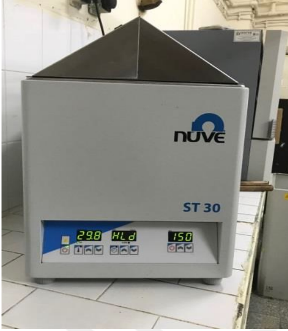
Şekil 3.4. Adsorpsiyon, Desorpsiyon çalışmalarda sıcaklık ayarlı çalkalama cihazı
