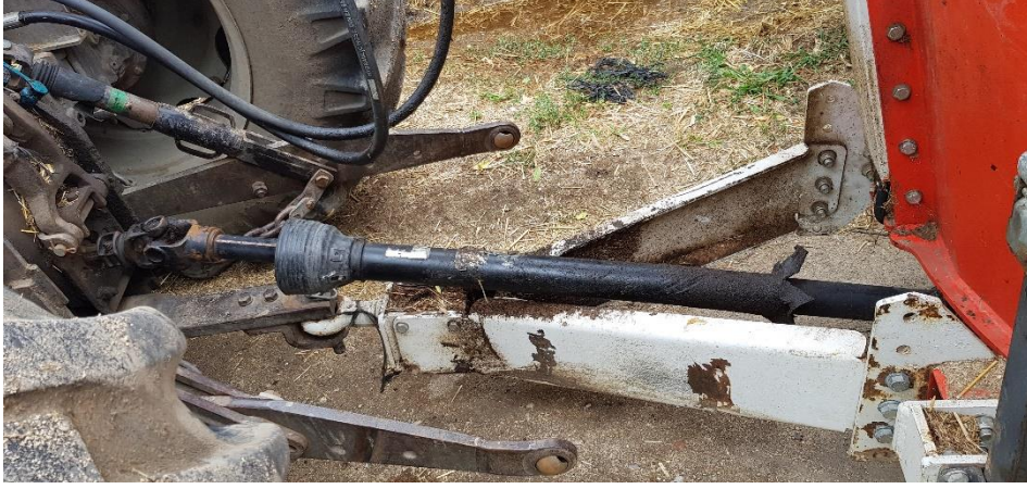
Şekil 3.8. Yem karma ve dağıtma makinesinin kuyruk miline bağlanması
