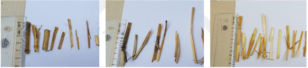
Şekil 3.19. Saman örneklerinin parça boyutlarının ölçülmesi
