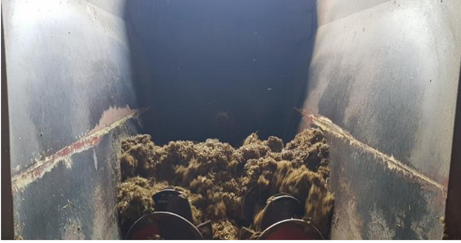
Şekil 3.13. YKM1 tip makinesinde silaj karıştırma işlemine ilişkin çalışmalardan örnek
