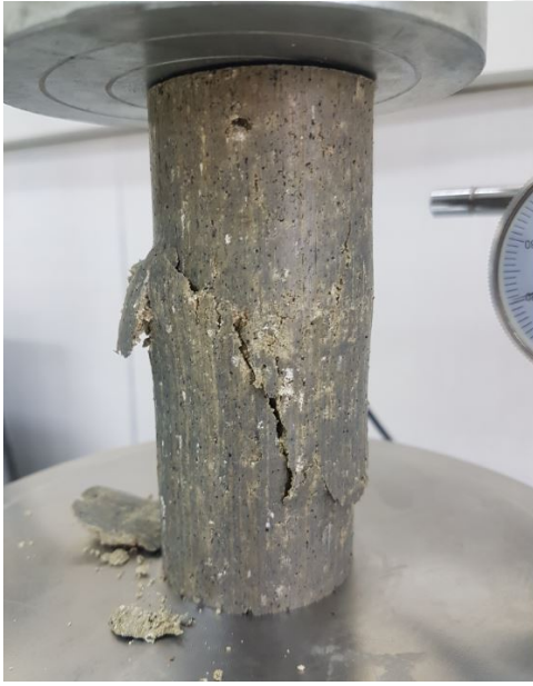
Şekil 3.10. Serbest basınç deneyi sonrası göçmüş numunenin görünümü
