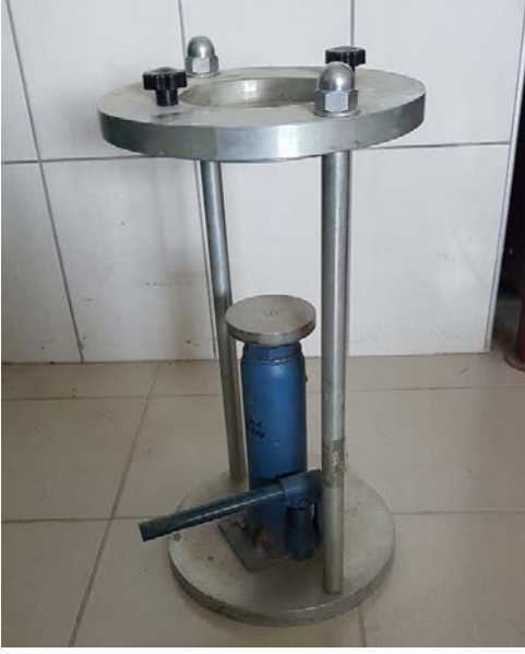
Şekil 3.6. Numune alıcı kriko
