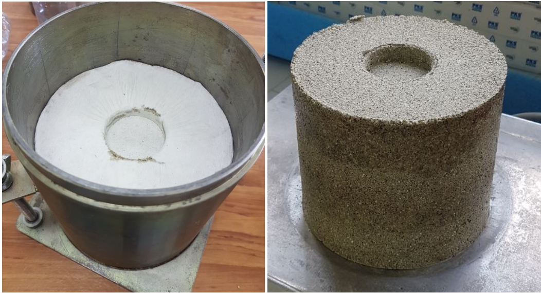
řekil 3.12. CBR deneyi sonrası numune rnekleri
