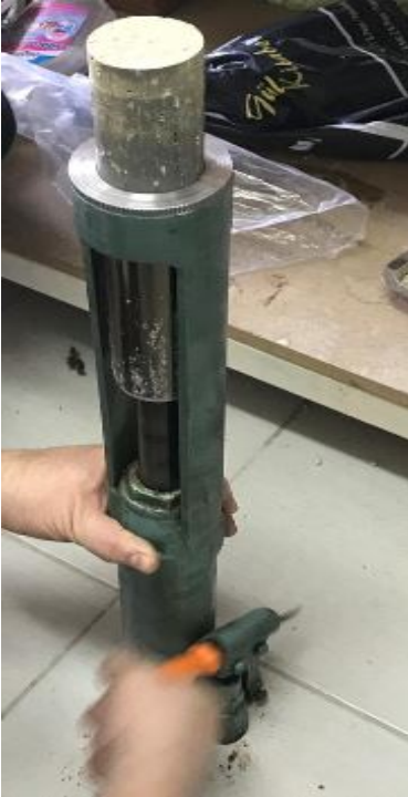
Şekil 3.7. Numune çıkarıcı kriko
