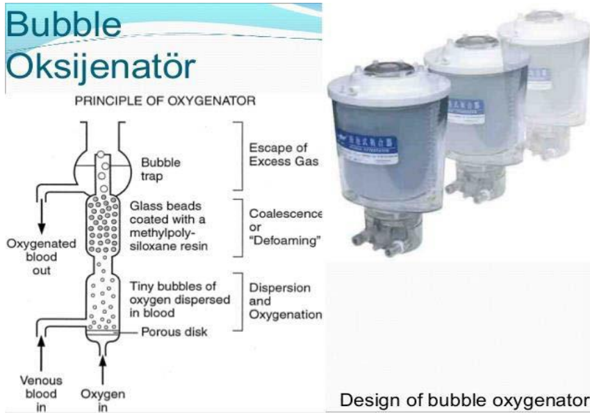
Şekil 2.3. Bubble Oksijenatör
