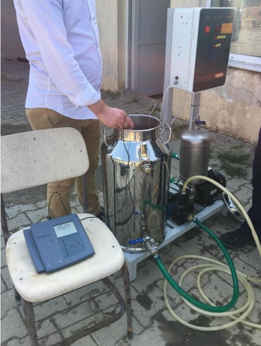
Şekil 4.1. Ozonlu yıkama suyunun ORP cihazı ile kontrolü
