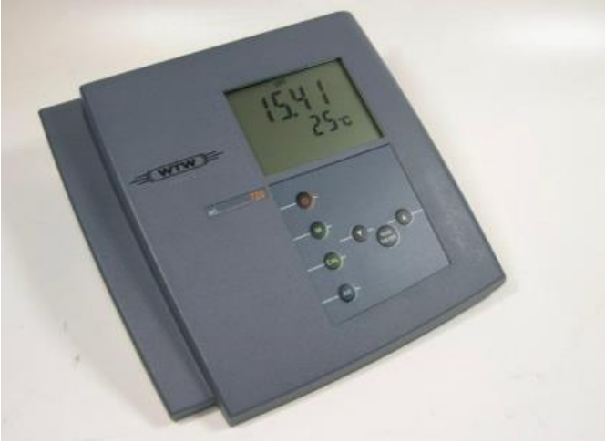
Şekil 3.3. Suda çözünen ozon miktarının ölçümü için kullanılan pH/ORP cihazı
