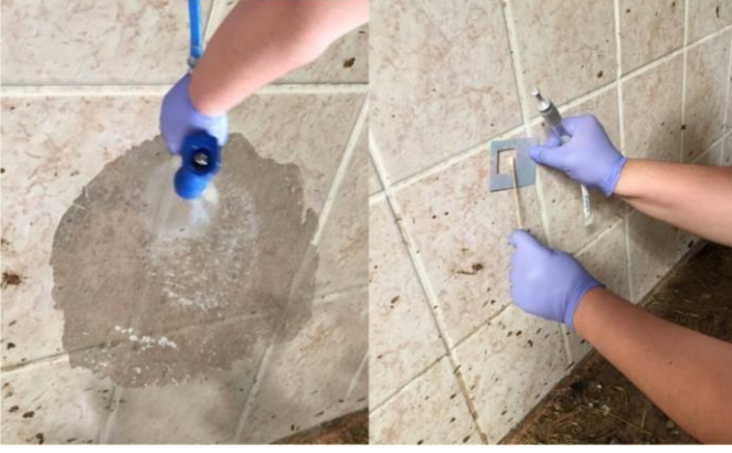
Şekil 3.5. Sağımhane duvarının yıkanması ve örnek alma
