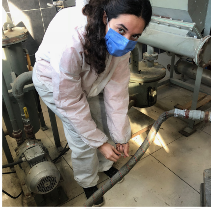
Şekil 3.9. Şırınga ile gaz örneklerinin alınması
