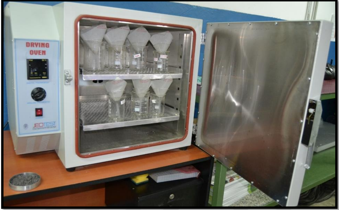
Şekil 3. 15. Asitte bekledikten sonra yıkanıp filtre kağıdı içinde etüvde 50 °C'de kurutulan sediman numuneleri
