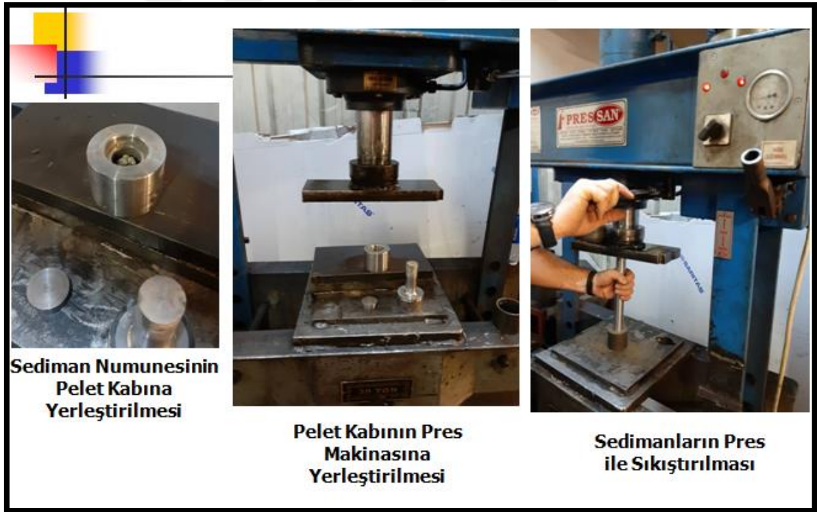
Şekil 3. 10. LİBS Analizi İçin Pelet Yapımı
