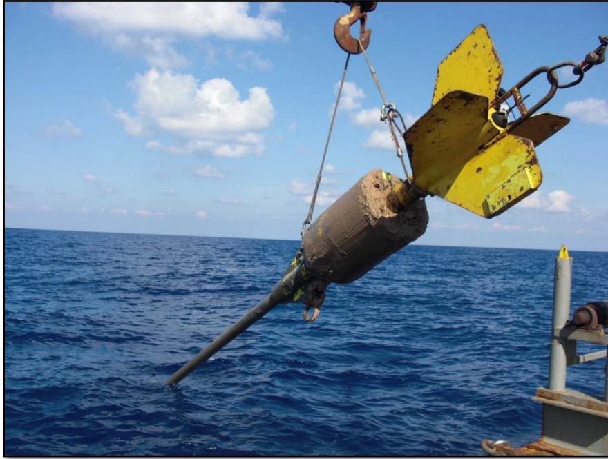
Şekil 3. 5. Numune alma ekipmanının serbest düşme ile denize bırakılması
