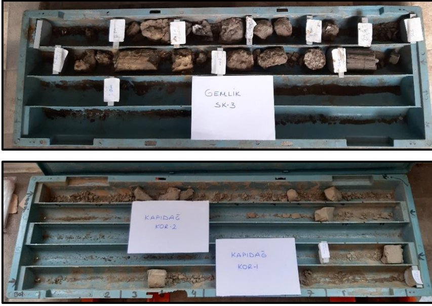
Şekil 3. 6. Gemlik ve Bandırma Körfezi'nden Alınan Kor ve Sondaj Karot Numune Örnekleri
