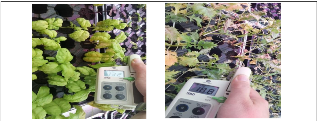
Şekil 3.21. Klorofilmetre yardımıyla denemedeki tüm bitkilerin fide hasat döneminde yaprak klorofil tayininin yapılması
