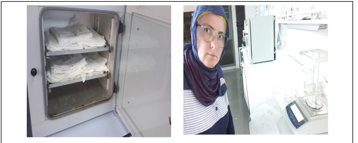
Şekil 3.15. Bitkilerin etüvde kurutulması ve kuru ağırlıklarının alınması
