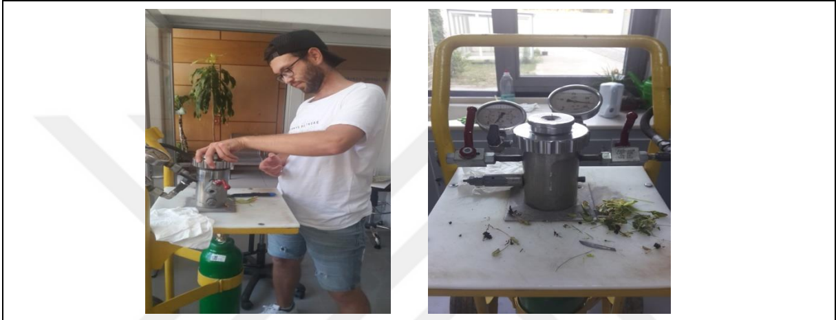
Şekil 3.16. Yaprak su potansiyelinin Scholander basınç odası ile ölçülmesi
