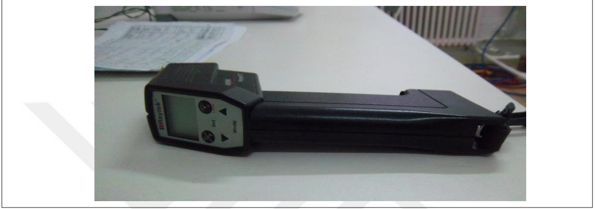
Şekil 3.20. İnfrared termometre (IRT) (Raynger ST8 model)
