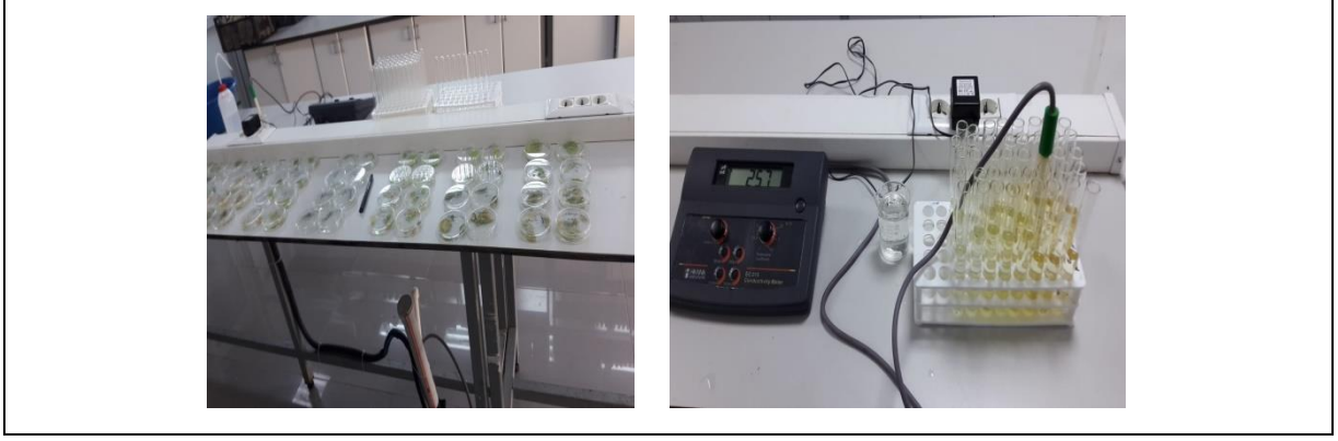
Şekil 3.17. Disklerin de-iyonize su içerisinde 5 saat bekletildikten sonra EC değerlerinin ölçülmesi
