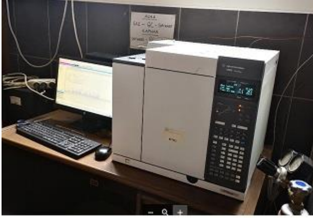
Şekil 3.4. Gaz analizlerinde kullanılan gaz kromatografi cihazı, yüksek saflıkta argon ve kuru hava tüpleri, referans gazı tüpü
