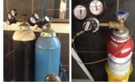
Şekil 3.4. Gaz analizlerinde kullanılan gaz kromatografi cihazı, yüksek saflıkta argon ve kuru hava tüpleri, referans gazı tüpü
