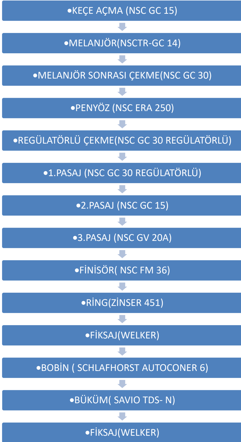
Şekil 4. 1. Çalışma kapsamında üretilen ipliklere ait iplik üretim hattı
