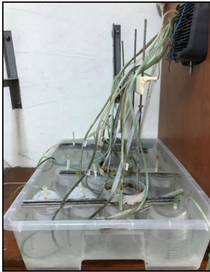
Şekil 3.5. Gaz-su yer değiştirme prensibiyle çalışan silindirler
