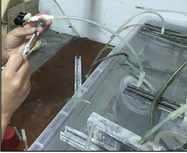
Şekil 3.6. Gazın silindirden alınması
