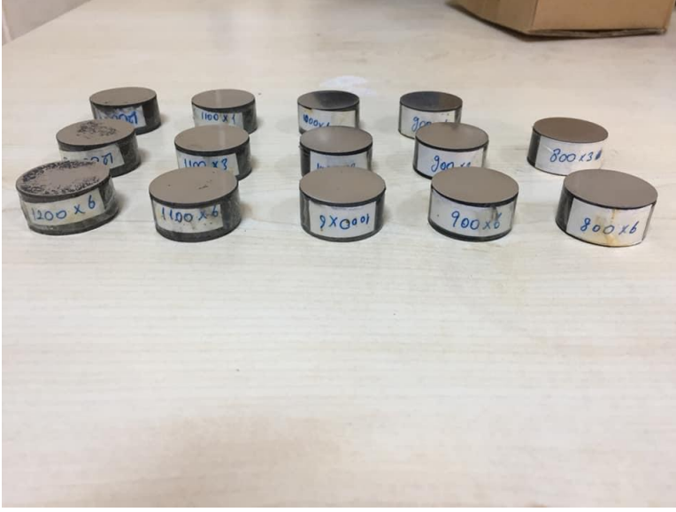
Şekil 7.2. 30 mm çapında ve 15 mm yüksekliğinde numuneler
