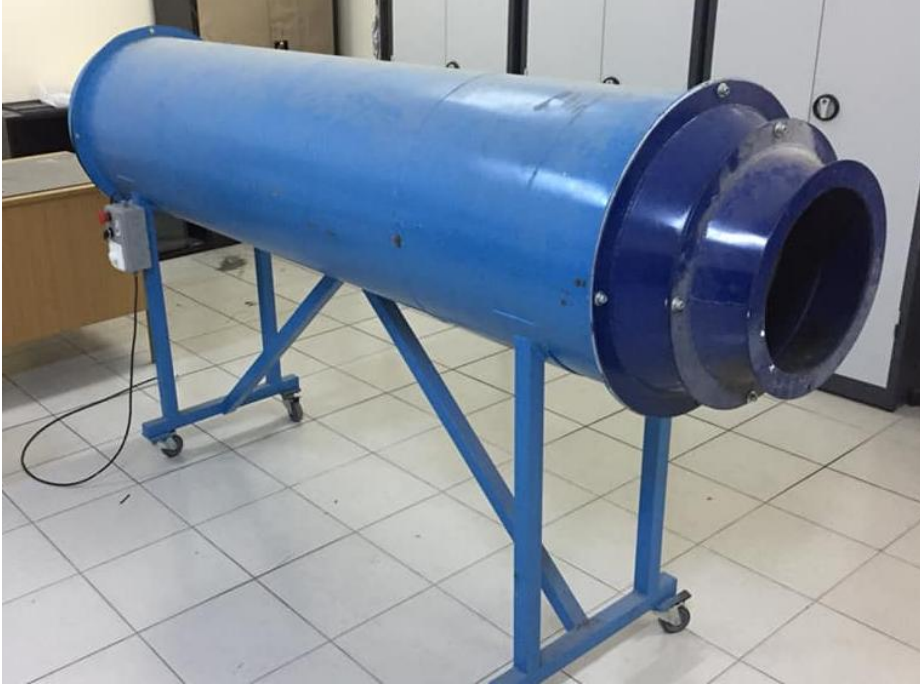
Şekil 7.4. Fanlı (hava) soğutma tüneli
