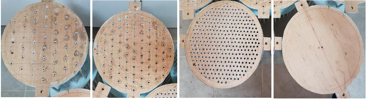
Şekil 5.2. Bitki Modelleri Detay Ölçüleri (Ölçüler metre olarak verilmiştir.) a)SVF 1 =%5, b) SVF 2 =%9, c) SVF 3 =%36, d)SVF 4 =%100
