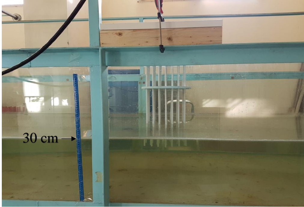
Şekil 5.8. Açık kanal düzeneği su derinliği ölçümü.
