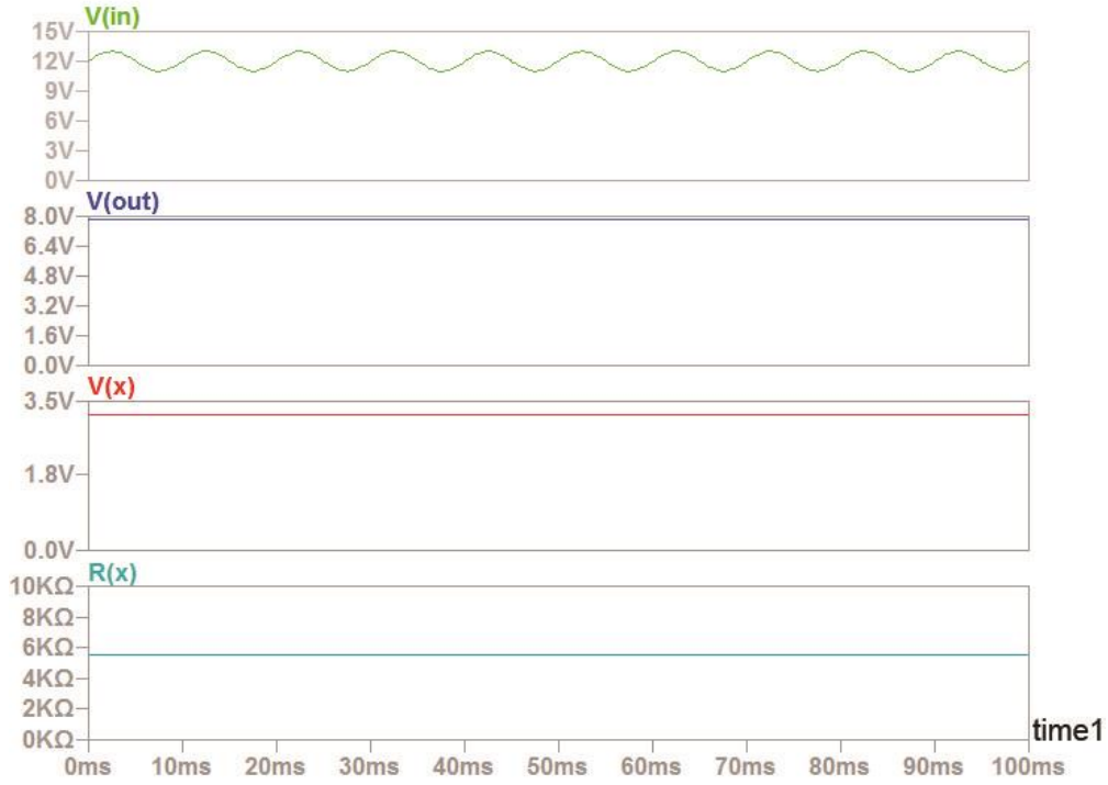
Şekil 5.2. Eşik gerilimi altında MTSVR-A devresinin zamana göre dalga biçimleri a) Giriş Gerilimi, b) Çıkış Gerilimi, c) Memristör Gerilimi, d) Memristör Direnci
