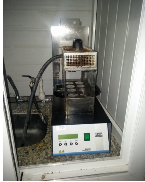
Şekil 3.19. Azot tayininde kullanılan VELP Scientifica UDK 120 cihazı.
