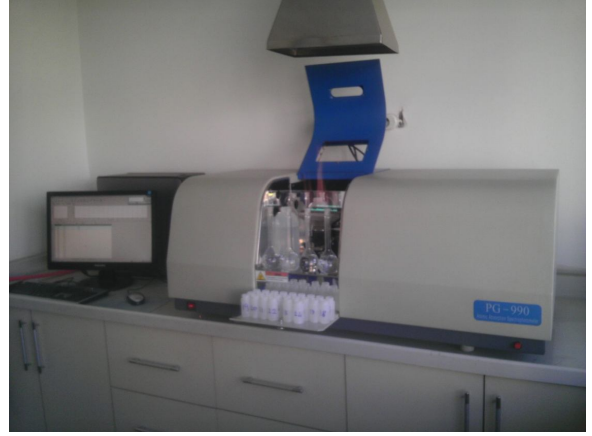
Şekil 3.20. Makro ve mikro elementlerinin belirlenmesinde kullanılan atomik absorpsiyon spektrometre cihazı.
