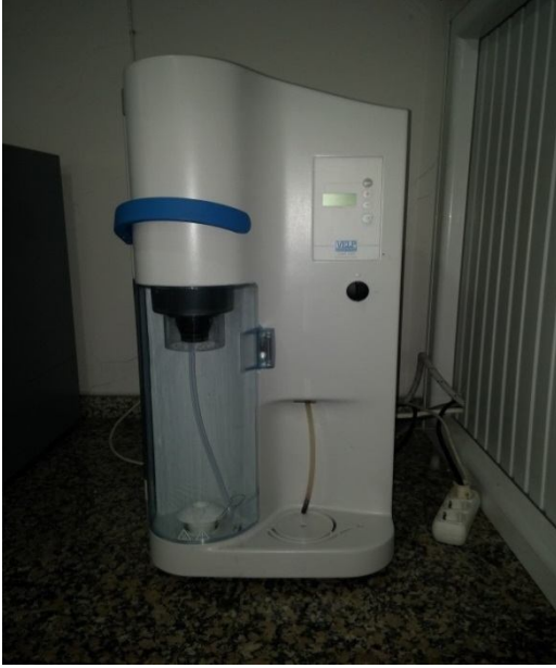
Şekil 3.19. Azot tayininde kullanılan VELP Scientifica UDK 120 cihazı.
