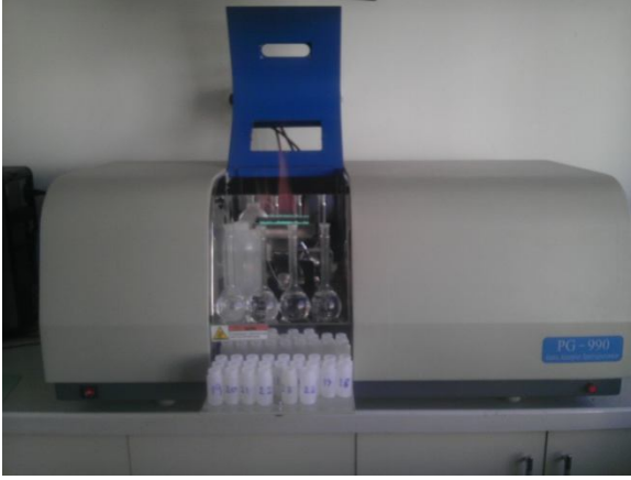
Şekil 3.20. Makro ve mikro elementlerinin belirlenmesinde kullanılan atomik absorpsiyon spektrometre cihazı.
