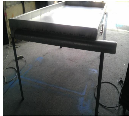
Şekil 3.8. Alt kolektör kasasının ön yüzeyine açılan hava giriş delikleri.
