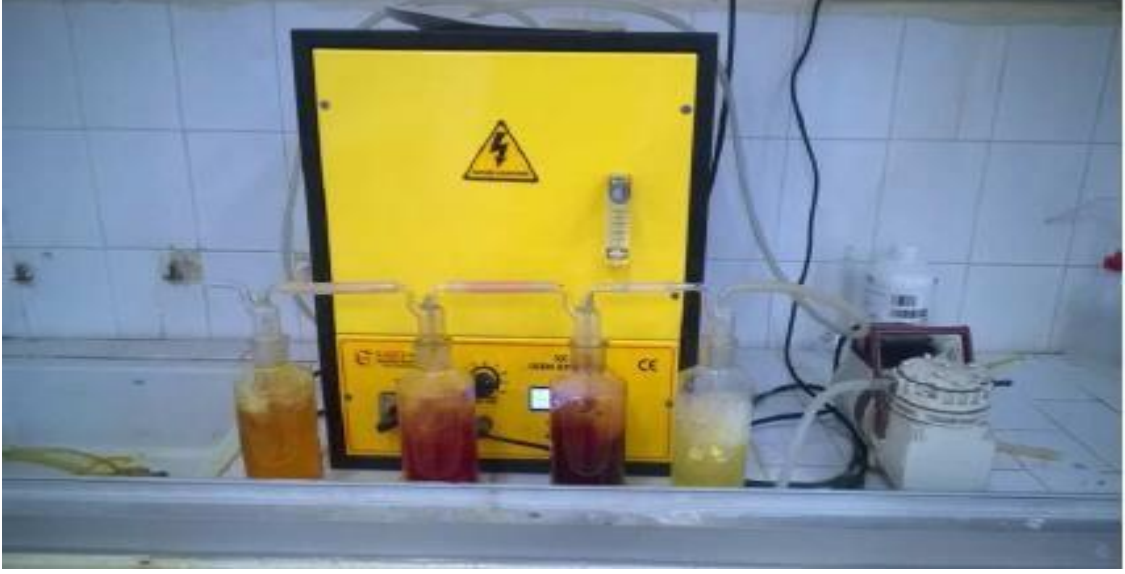
Şekil 3.2. Ozon oksidasyon deneyi düzeneği.
