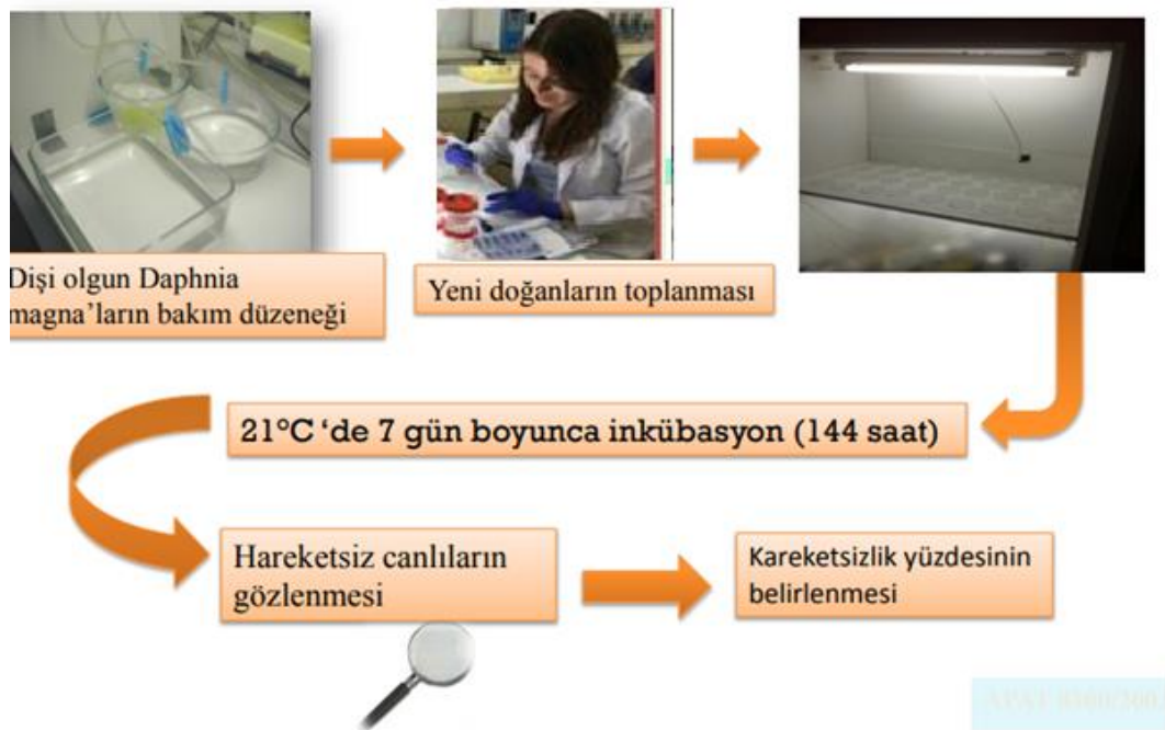
Şekil 3.6. Daphnia magna kronik toksisite deneyinin yürütülüşü
