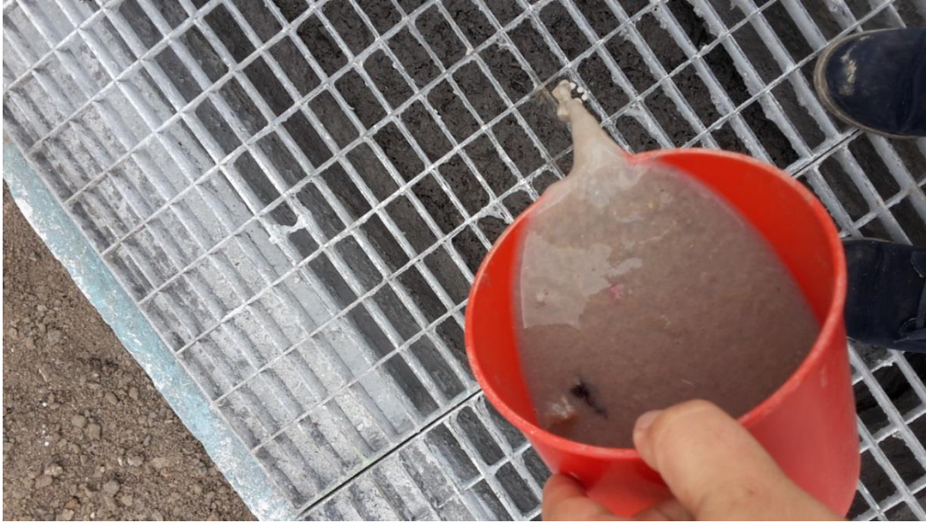
Şekil 3.1. Tesise giren atık suya ait görüntü
