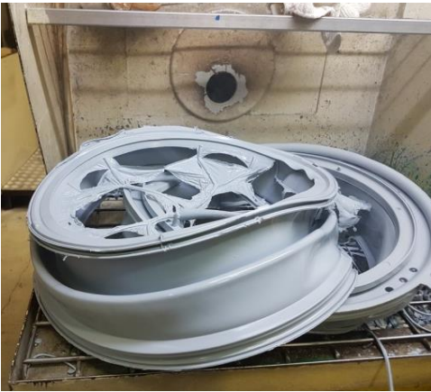
Şekil 3.5. Çapak temizliği yapılacak malzeme örneği
