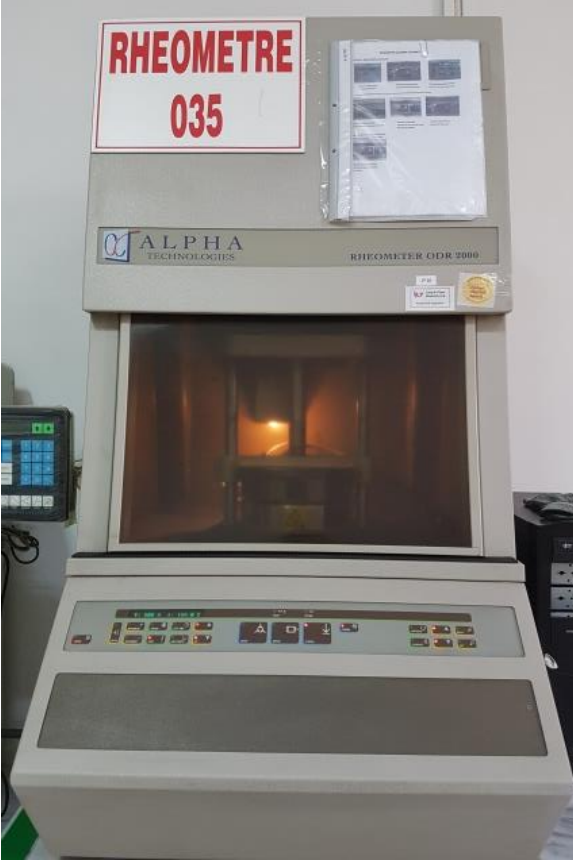
Şekil 3.10. Rheometre test cihazı
