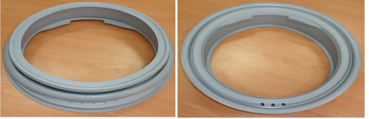
Şekil 3.3. Çalışma kapsamında üretilen conta örneği
