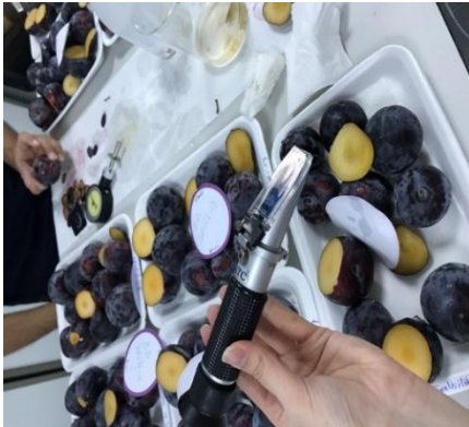
Şekil 3.6. SÇKM miktarının refraktometre ile ölçülmesi.
