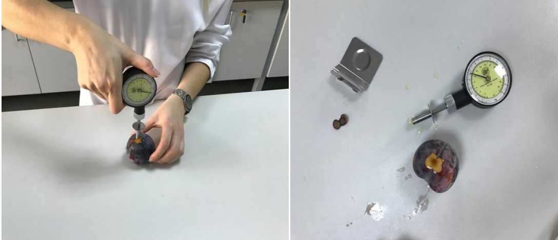
Şekil 3.8. Meyve sertliğinin penetrometre ile ölçülmesi
