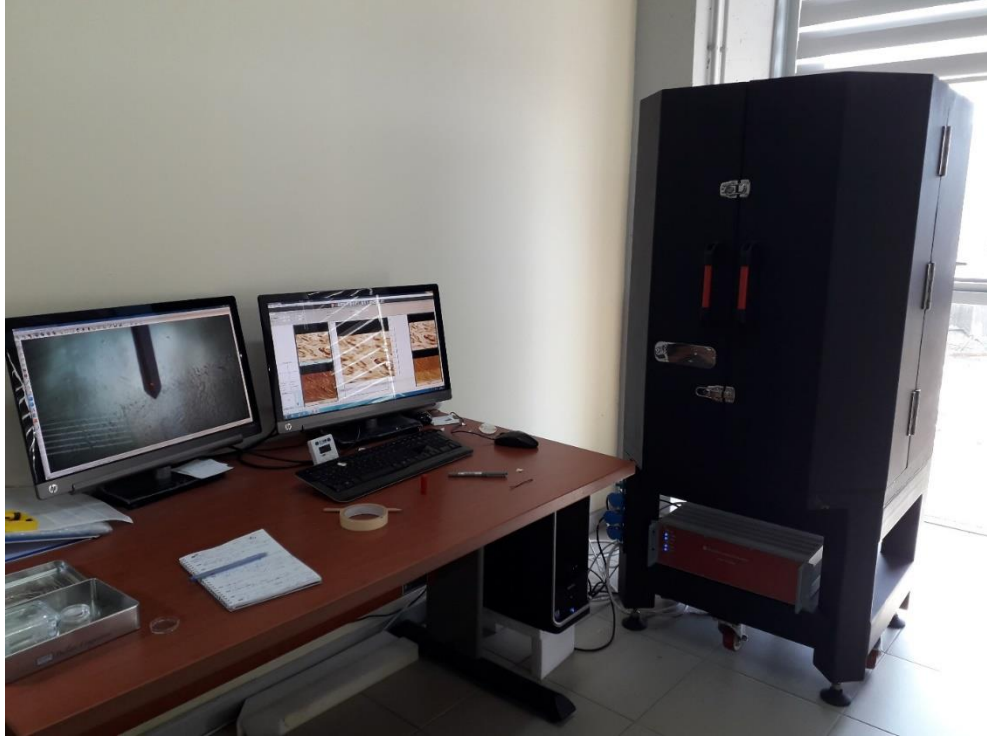
Şekil 4.10. Kırmızı kan hücrelerinin görüntülenmesi için kullanılan AFM.
