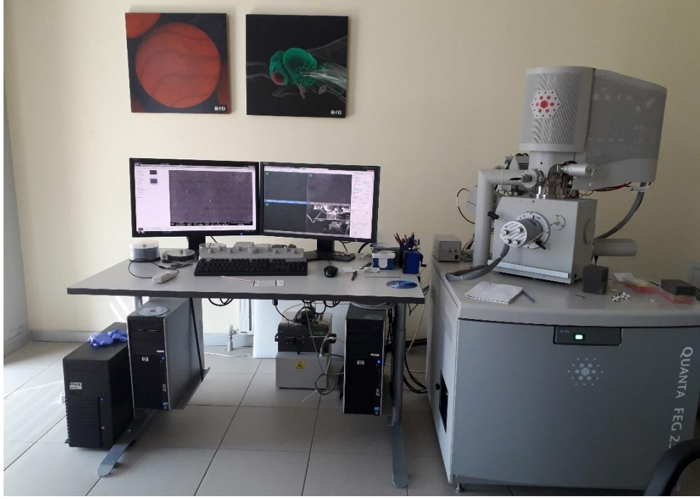
Şekil 4.14. Kırmızı kan hücrelerinin görüntülenmesi için kullanılan SEM
