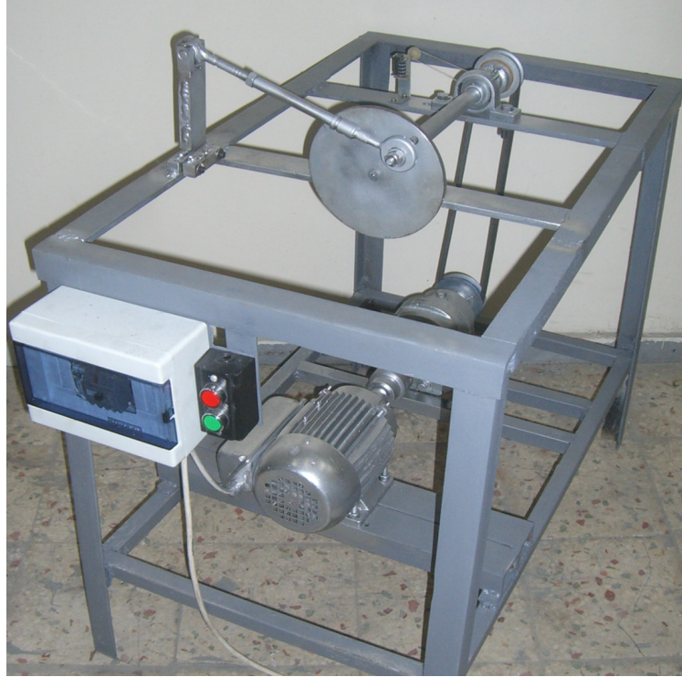
Şekil 3.2. İleri-Geri Eğme Yorulması Test Düzeneği
