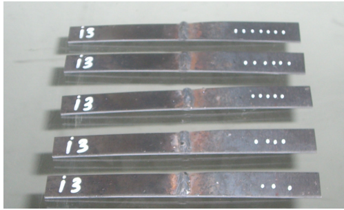
Şekil.3.4 Eğme yorulması test örnekleri plakalardan kesilmiş ve markalanmış görünümü
