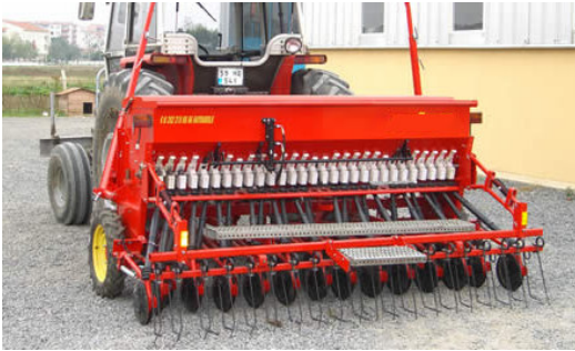
Şekil.1.3c Çift Diskli Gübresiz Üiversal Ekim Makinesi
