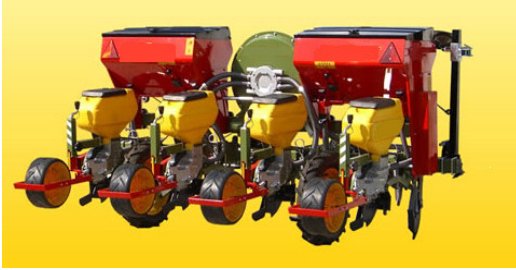
Şekil.1.3a 4 Sıralı Gübrelili Pnömatik Ekim Makinesi
