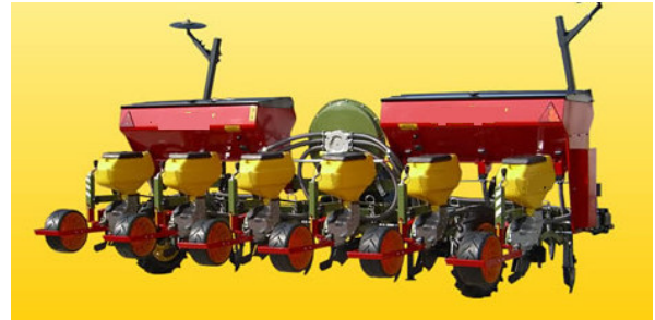
Şekil.1.3d 6 Sıralı Gübrelili Pnömatik Ekim Makinesi
