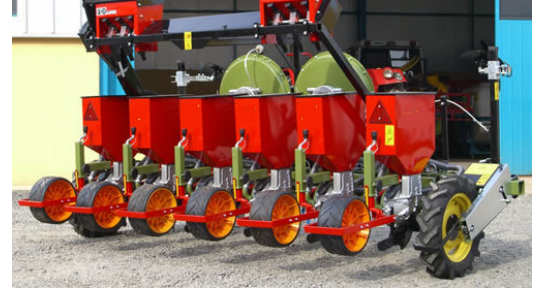
Şekil.1.3f Çıft Fanlı Toz İlaçlamalı İrı Tohum Atabilen (Bakla, Fasulye v.b.) Pnömatık Ekım Makınesı
