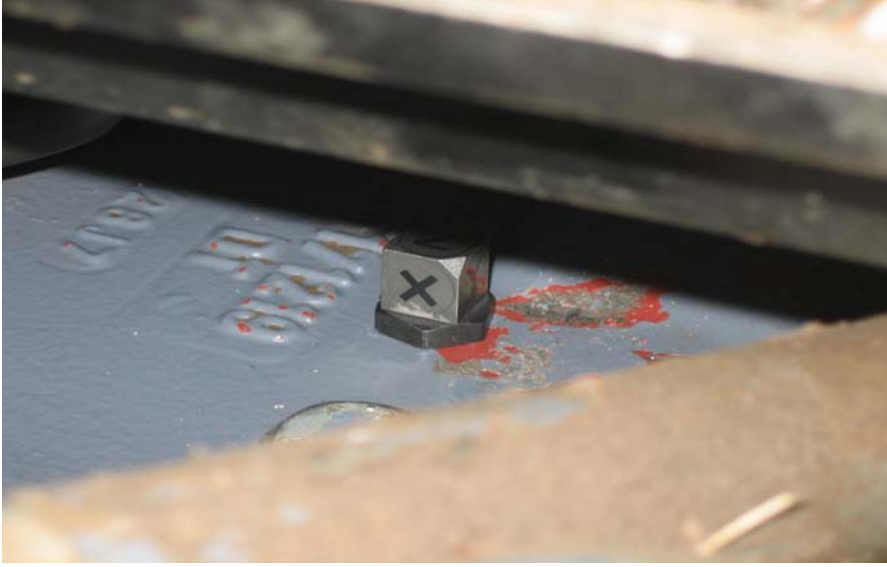
Şekil 3.19. Üçüncü sensörün montajı
