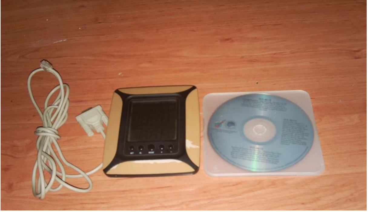
Şekil 3.1. Sera içi sıcaklığını ölçmede kullanılan temperaturstation aleti
