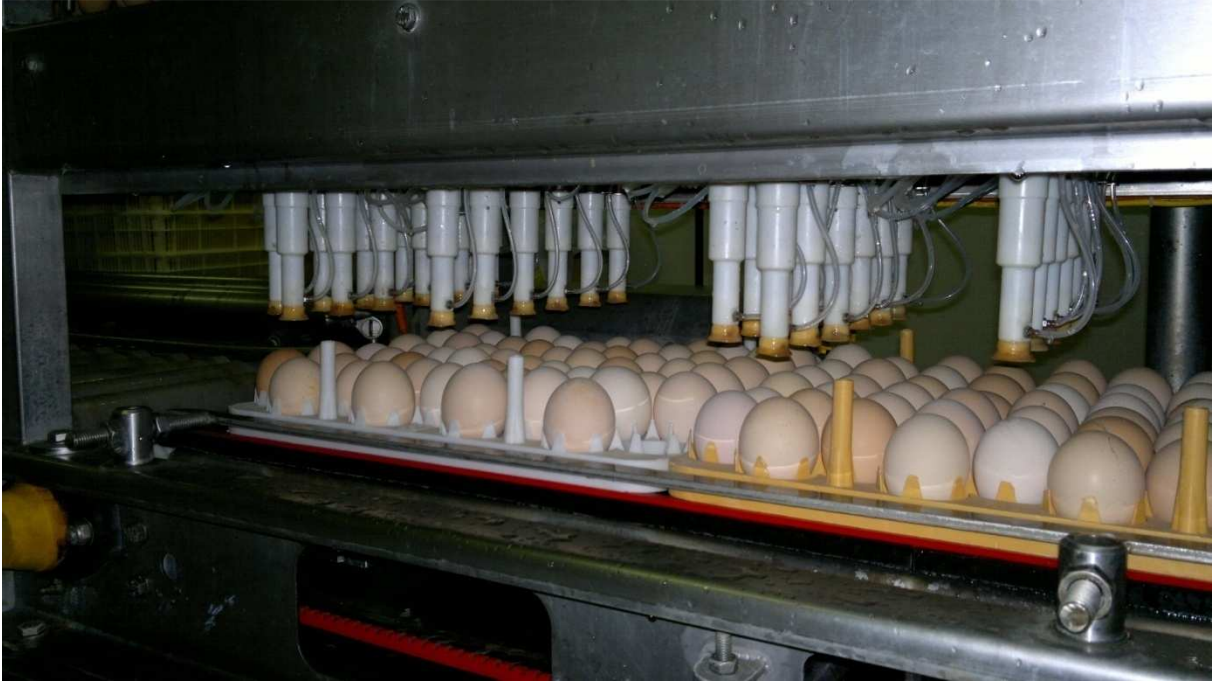
Şekil 2. İn Ovo Enjeksiyon Makinasında Yumurtalar
