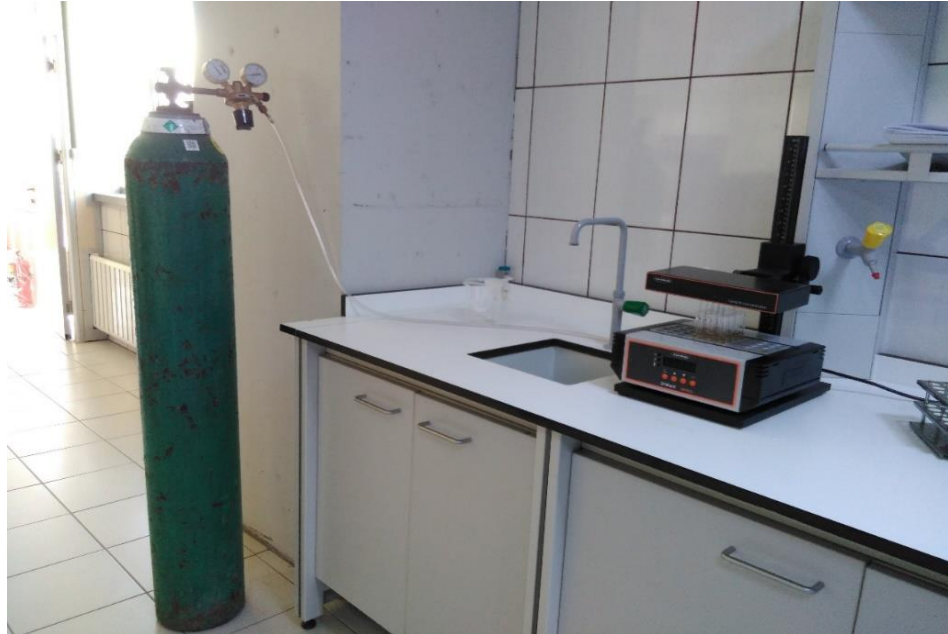
Şekil 3. 8: Adsorbe Edilen Atıksu Numunelerinin Azot Altında Uçurulması
