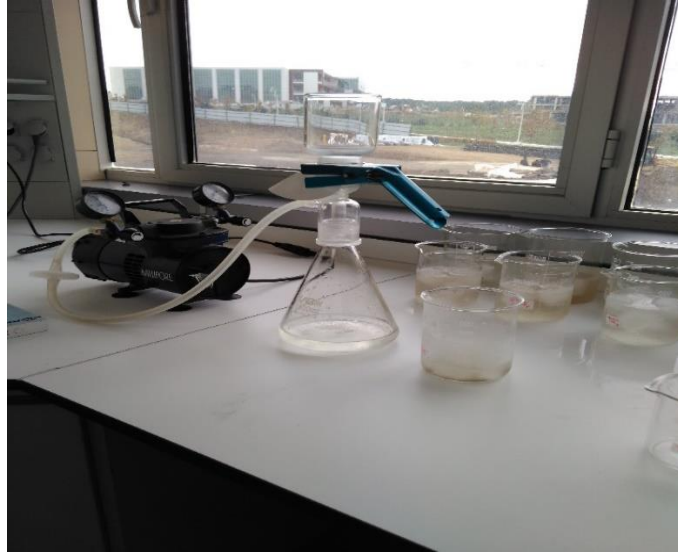
Şekil 3. 5: Atıksu Numunelerinin Filtreden Geçirilmesi
