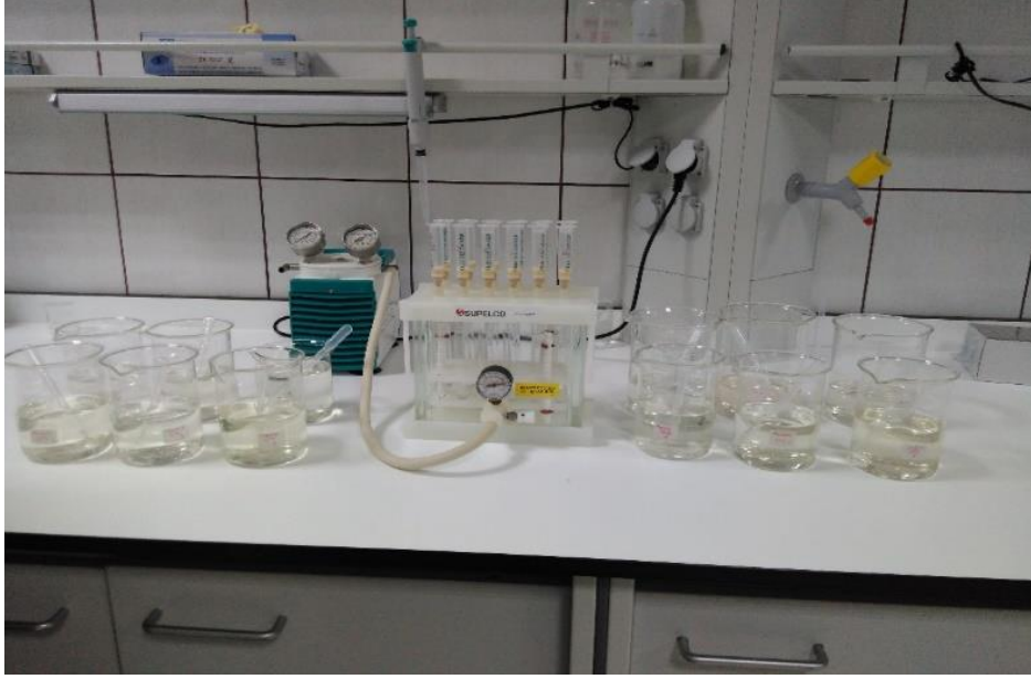
Şekil 3. 6: Atıksu Numunelerinin SPE Kartuşlardan Geçirilmesi
