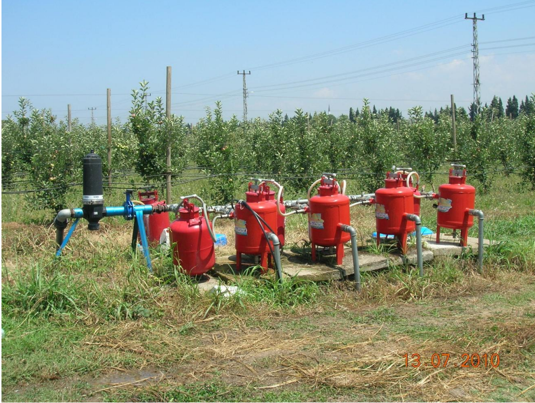
Şekil 3.4. Gübreleme yapılabilmesi amacıyla kurulan gübre tankı ve filtreleme ünitelerinin bulunduğu fertigasyon ünitesi
