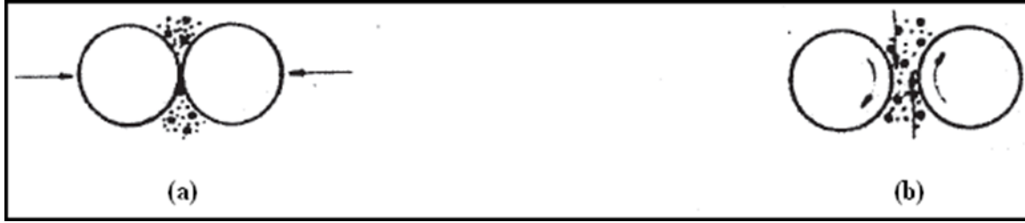
Şekil 3.8. Atritör değirmeninde öğütme esnasında oluşan hareketler, (a) darbe, (b) kesme
