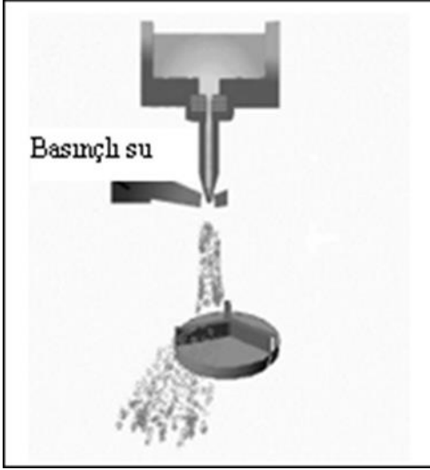
Şekil 2.8. Döner disk ile atomizasyon yöntemi [12]
