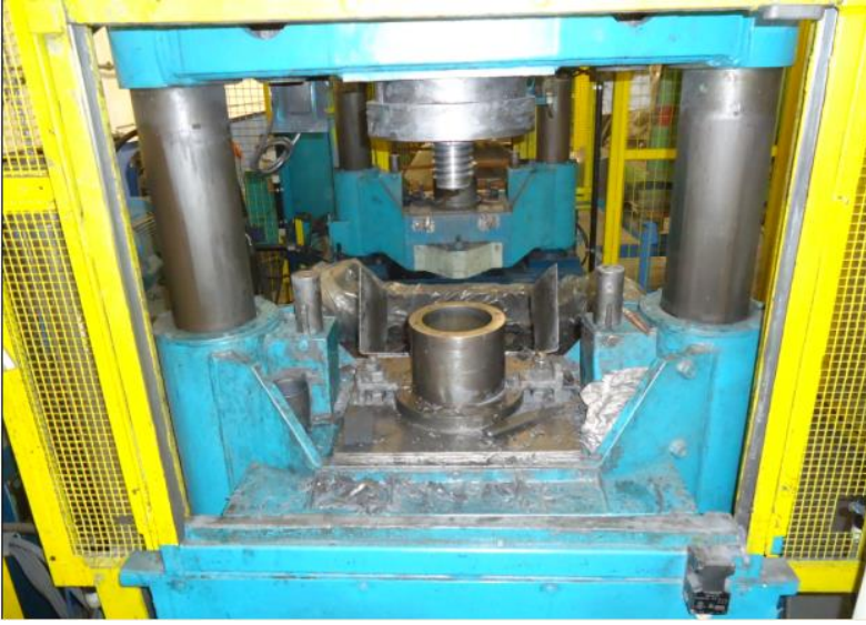
Resim 3.9. 100 Tonluk Pres altına kalıbın yerleştirilmesi
