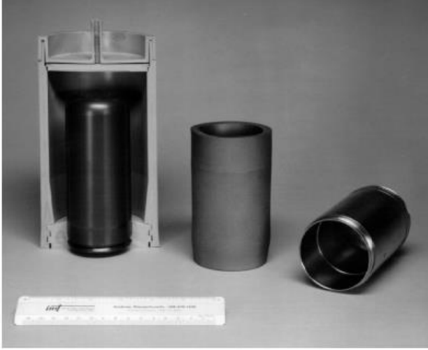
Resim 3.3. İzostatik Pres Grafit Nozul Kalıbı
