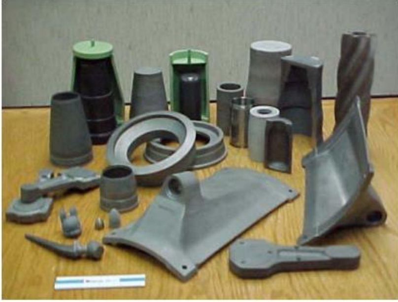
Resim 3.5. İzostatik Pres ile Üretilmiş Ürünler
