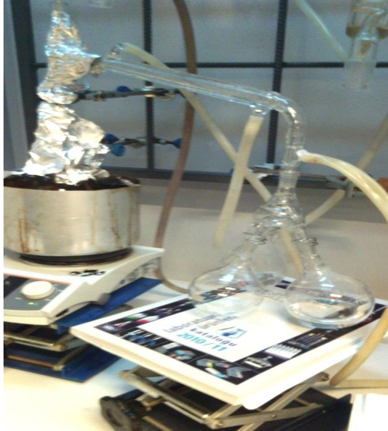
Şekil.4.3. Morfolin enamin sentezindeki son aşama olan vakumda ayrımsal damıtma düzeneđi
