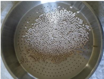
Şekil 3.20. Dayanıklılık direnci test sonrası görünümü
