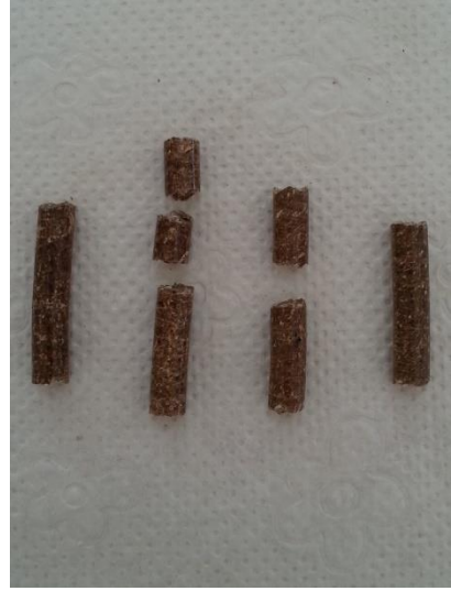
Şekil 4.5. Karışım 2 peleti kırılma testi öncesi (a) ve test sonrası (b) görünüşleri
