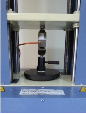
Şekil 3.21. Pelet sıkıştırma testi
