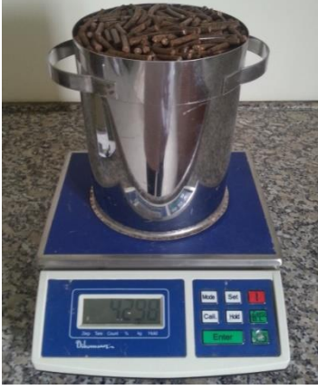
Şekil 3.19. Pelet hacim yoğunluğunun belirlenmesi
