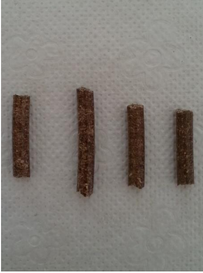
Şekil 4.5. Karışım 2 peleti kırılma testi öncesi (a) ve test sonrası (b) görünüşleri
