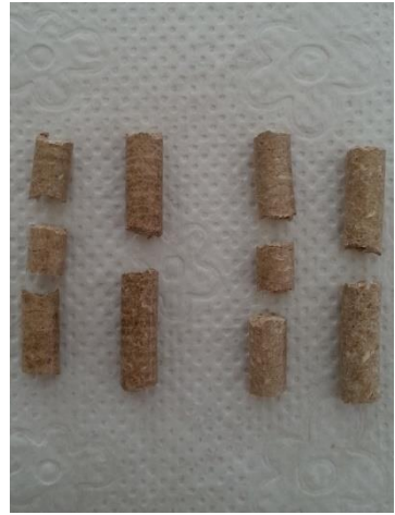
Şekil 4.8. Karışım 5 peleti kırılma testi öncesi (a) ve test sonrası (b) görüntüleri
