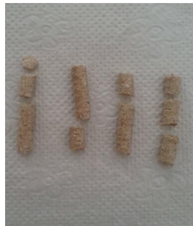
Şekil 4.9. Karışım 6 peleti kırılma testi öncesi (a) ve test sonrası (b) görüntüleri
