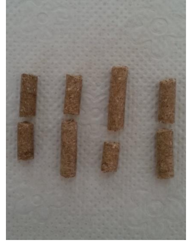
Şekil 4.7. Karışım 4 peleti kırılma testi öncesi (a) ve test sonrası (b) görüntüleri
