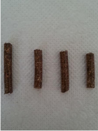
Şekil 4.4. Karışım 1 peleti kırılma testi öncesi (a) ve test sonrası (b) görünüşleri
