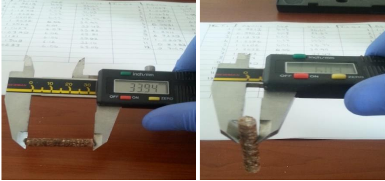
Şekil 3.18. Pelet parça yoğunluğunun belirlenmesi
