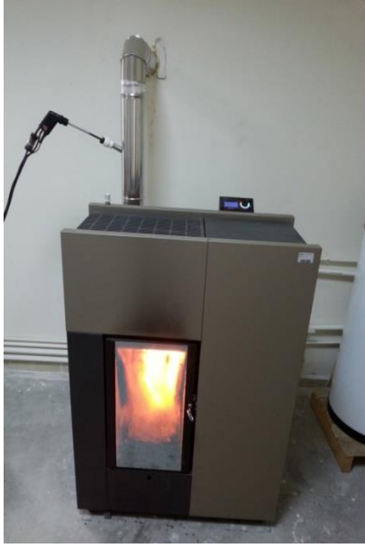
Şekil 3.22. Baca gazı ölçüm cihazı algılayıcısının soba üzerine yerleştirilmesi
