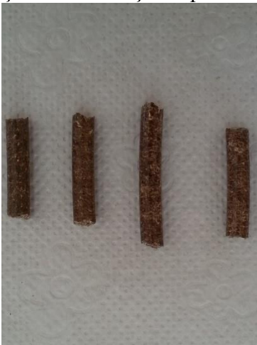
Şekil 4.6. Karışım 3 peleti kırılma testi öncesi (a) ve test sonrası (b) görünüşleri
