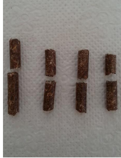
Şekil 4.4. Karışım 1 peleti kırılma testi öncesi (a) ve test sonrası (b) görünüşleri
