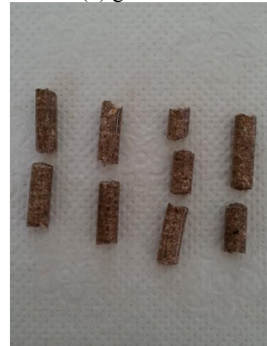
Şekil 4.6. Karışım 3 peleti kırılma testi öncesi (a) ve test sonrası (b) görünüşleri
