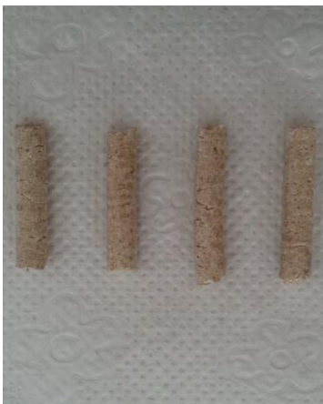
Şekil 4.9. Karışım 6 peleti kırılma testi öncesi (a) ve test sonrası (b) görüntüleri
