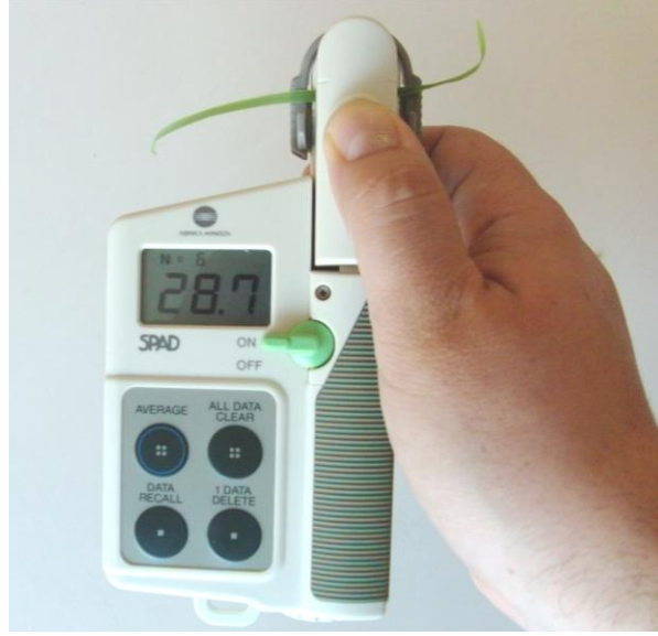
Şekil 3.1. Klorofilmetre (Konica Minolta SPAD-502)
