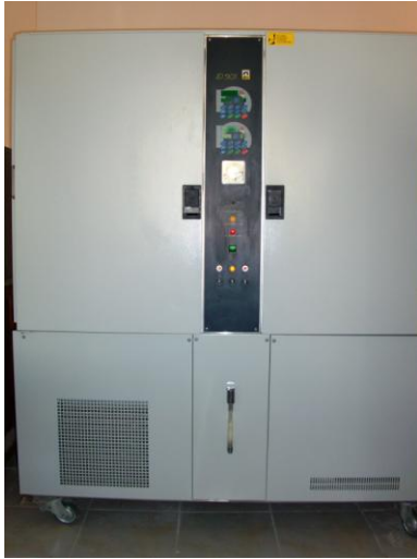
Şekil 3.5. Laboratuvarında çimlenme-fide denemelerinin yürütüldüğü iklimlendirme dolabı
