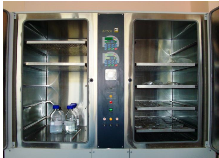
Şekil 3.5. Laboratuvarında çimlenme-fide denemelerinin yürütüldüğü iklimlendirme dolabı
