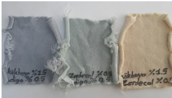
Şekil 4.4: Zerdeçal, kök boya ve indigo kullanılarak yapılan ikili karışım boyamalara ait numuneler
