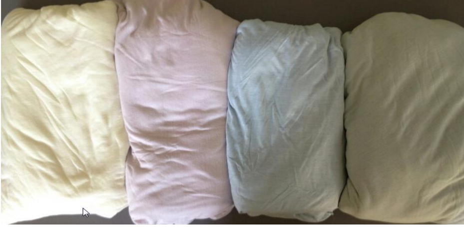
Şekil 4.5: İşletme koşullarında zerdeçal, kök boya, indigo ve indigo→zerdeçal ile boyanmış kumaş numunelerine ait fotoğraflar
