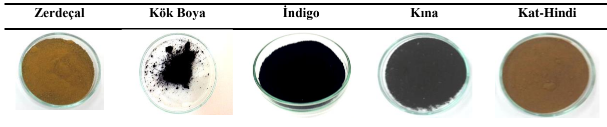
Çizelge 4.4: Zerdeçal, kök boya, indigo, kına ve kat-hindiden elde edilen toz boyalar
