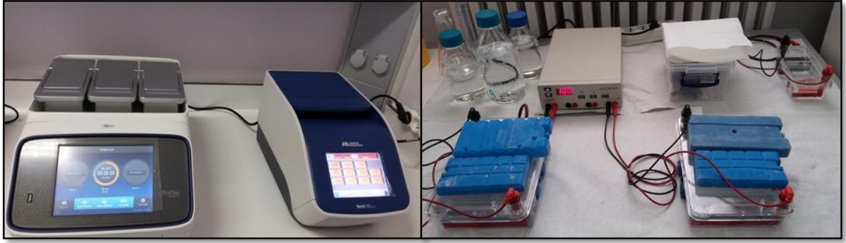
Şekil 3.9. Thermal Cycler cihazlarında DNA amplifikasyonları ve Elektroforez
