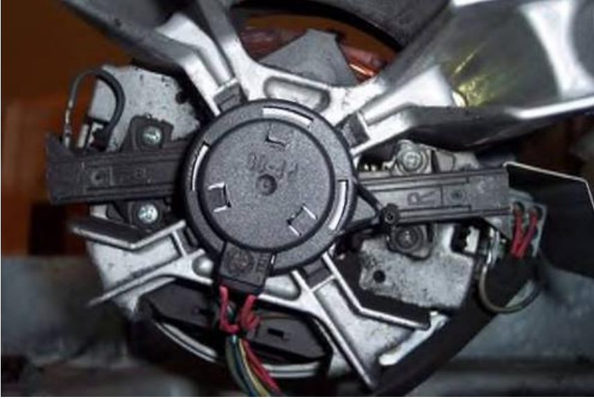
Şekil 1.14 Fırçaların motor üzerindeki montaj hali (Anonim 2015)
