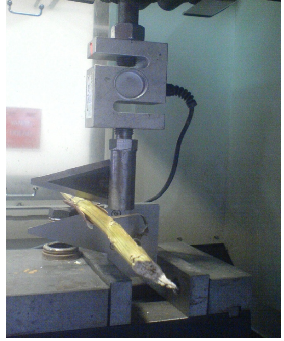
Şekil 3.19. Kesme Kuvvetinin Saptanmasında Kullanılan Düzenekte Kesme İşlemi Esnasındaki Görünümleri
