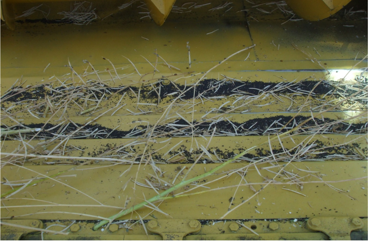
Şekil 4.12. Kanola Hasat Tablası Takılı Biçerdöverde Hasat Esnasında Tablada Üzerinde Kalan Tanelerin Görünümü
