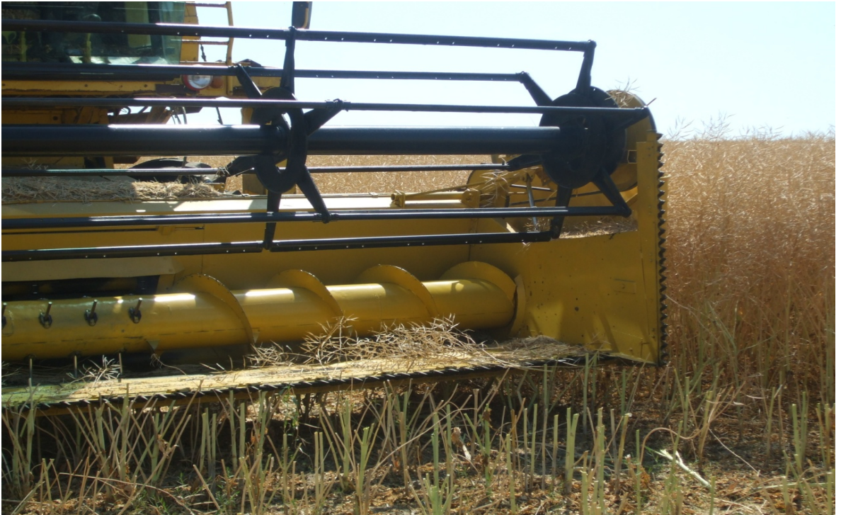
Şekil 3.7. Mekanik Tip Kanola Hasat Tablası İle Deneme Tarlasından Görünüm
