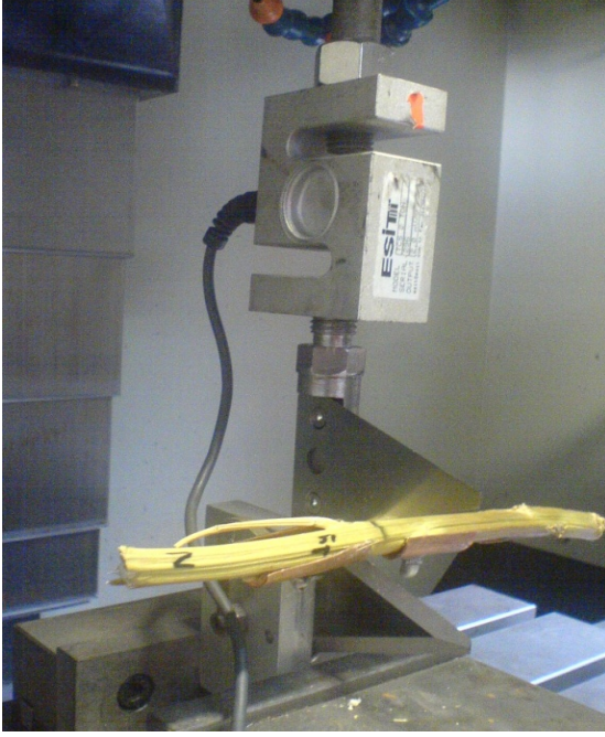
Şekil 3.19. Kesme Kuvvetinin Saptanmasında Kullanılan Düzenekte Kesme İşlemi Esnasındaki Görünümleri
