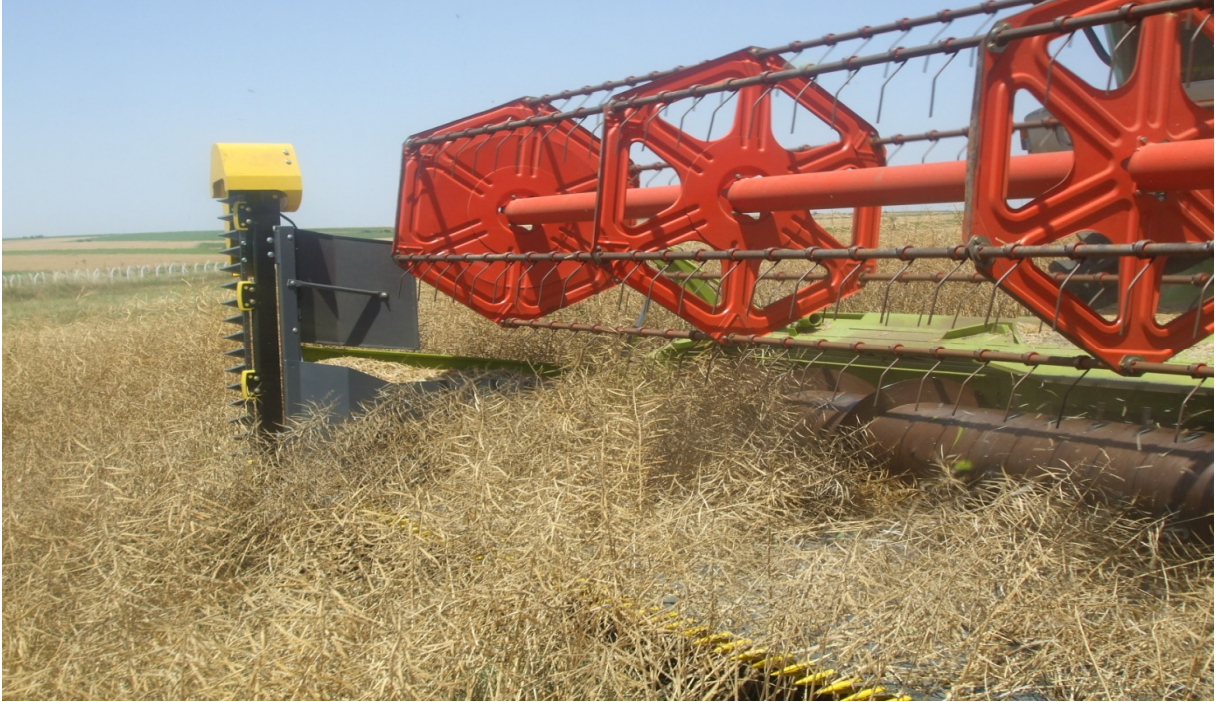
Şekil 3.5. Motorlu Tip Kanola Hasat Tablası ile Deneme Tarlasından Görünüm
