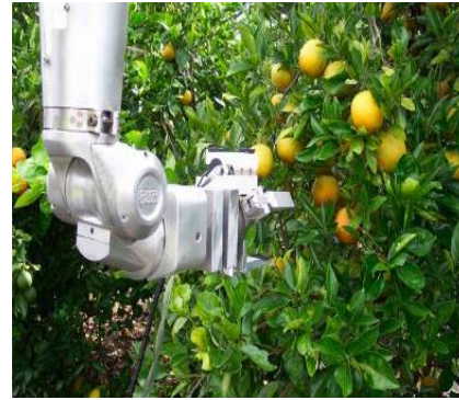
Şekil 3. Robotik portakal hasadı (Hannan and Burks 2004)
