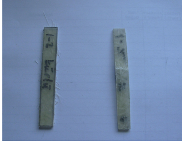
Şekil 4.41. Ortoftalik Reçine Kırpık Cam Elyaf Takviyeli Kompozit Numunenin Eğilme Deneyi Sonrası Görüntüleri
