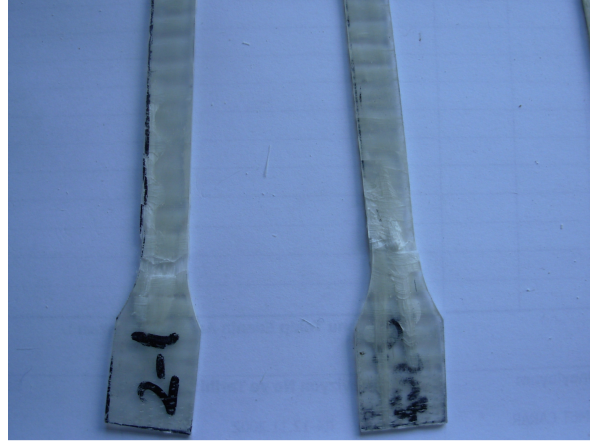
Şekil 4.21. Ortoftalik Matrisli 90^0 Dokuma Cam Elyaf Takviyeli 4 Tabakalı Kürsüz Kompozit Numunenin Çekme Deneyi Sonrası Örnekleri
