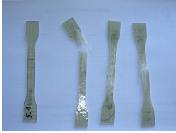
Şekil 4.19. Vinil Ester Matrisli Dokuma Cam Elyaf Takviyeli 4 Tabakalı Kürlü Kompozit Numunenin Çekme Deneyi Sonrası Örnekleri
