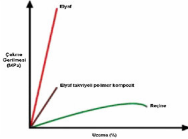
Şekil 1.13. Kompozit Yapı ile Geliştirilen Çekme-Uzama Özelliği (Sayman 1978)
