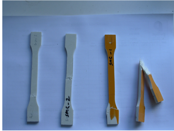
Şekil 4.22. A ve B Firmalarına Ait Kompozit Numunenin Çekme Deneyi Sonrası Örnekleri
