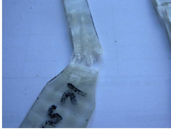
Şekil 4.20. Vinil Ester Matrisli Dokuma Cam Elyaf Takviyeli 4 Tabakalı Kürsüz Kompozit Numunenin Çekme Deneyi Sonrası Örnekleri
