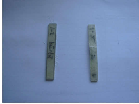
Şekil 4.46. Vinil Ester Matrisli 90^0 Dokuma Cam Elyaf Takviyeli 4 Tabakalı Kürsüz Kompozit Numunenin Darbe Deneyi Sonrası Örnekleri
