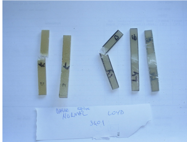
Şekil 4.45. Vinil Ester Matrisli 90 0 Dokuma Cam Elyaf Takviyeli 2 Tabakalı Kürlü Kompozit Numunenin Darbe Deneyi Sonrası Örnekleri
