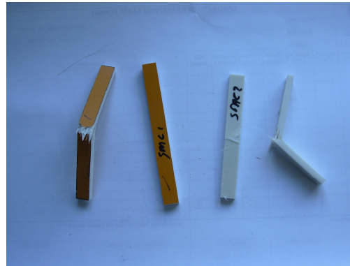
Şekil 4.48. A ve B Firmalarına Ait Kompozit Numunenin Darbe Deneyi Sonrası Örnekleri
