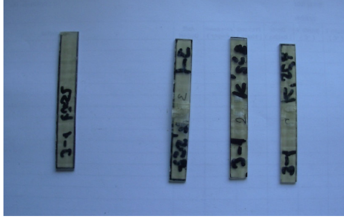
Şekil 4.43. Ortoftalik Reçine 90 0 Dokuma 2 Tabakalı Kompozit Numunenin Eğilme Deneyi Sonrası Görüntüleri
