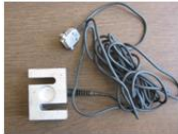
Şekil 3. Çeki kuvveti ölçme sensörü
