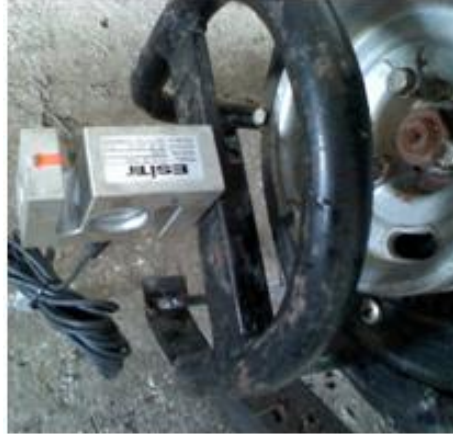
Şekil 7. Çeki kuvveti ölçerin tek akslı traktöre montajı
