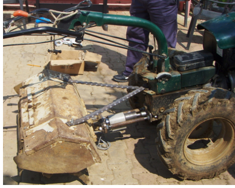
Şekil 6. Torquemeterin tek akslı traktör ve toprak frezesi arasına montajı
