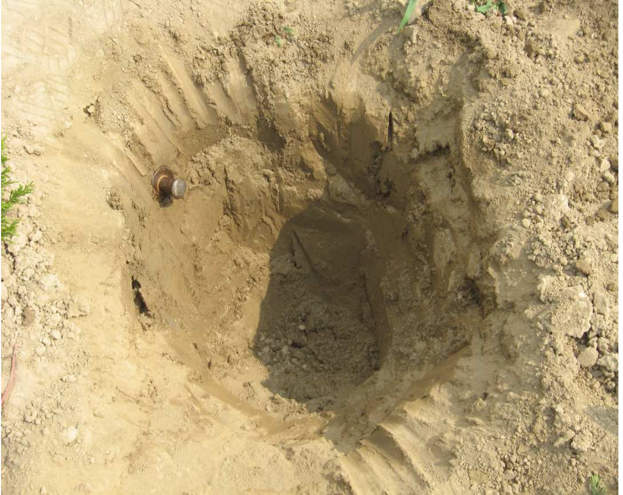
Şekil 3.12. Arazi koşullarında bozulmamış toprak örneklerinin alınışı
