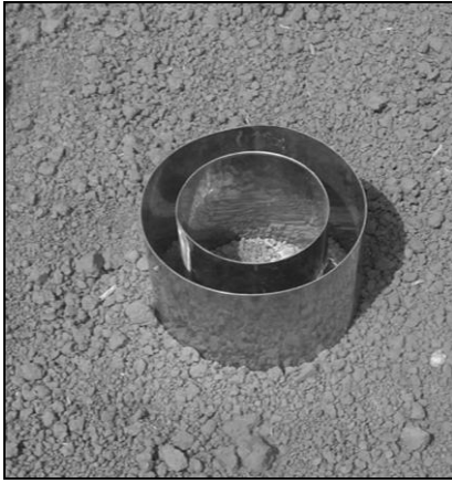
Şekil 1. Toprağın infiltrasyon parametrelerini belirlemede kullanılan çift silindir infiltrometre
