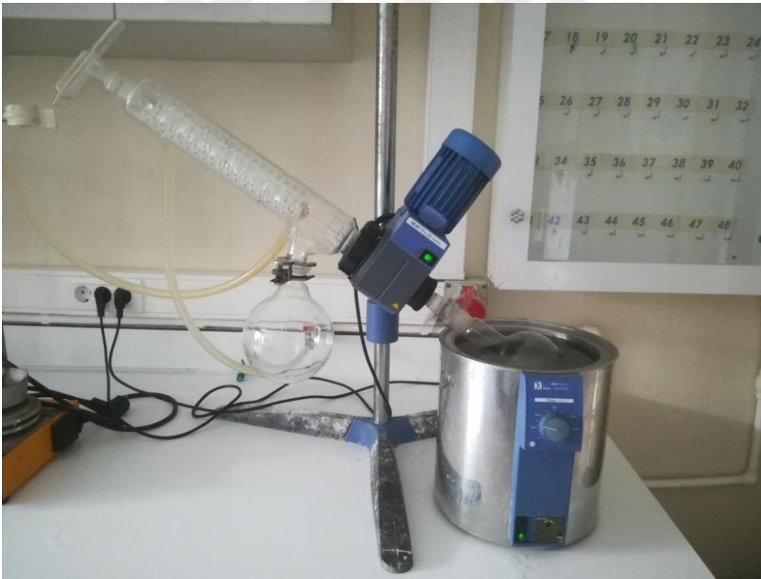
Şekil 3.7. Rotaryde hekzan temizleme aşaması
