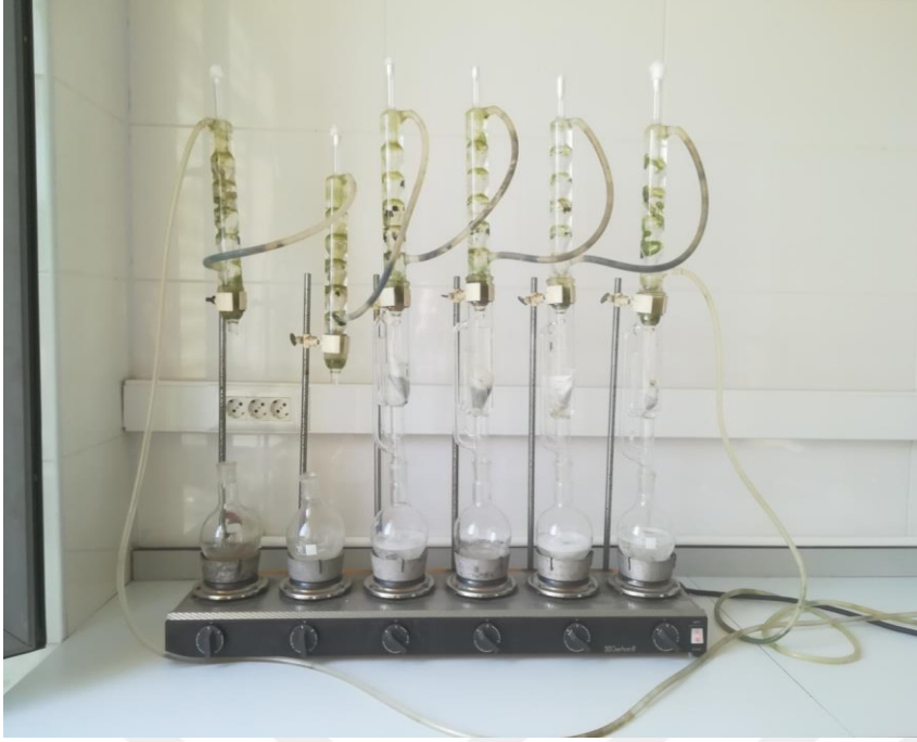
Şekil 3.6. Yağ analizinde kullanılan soxhlet cihazı
