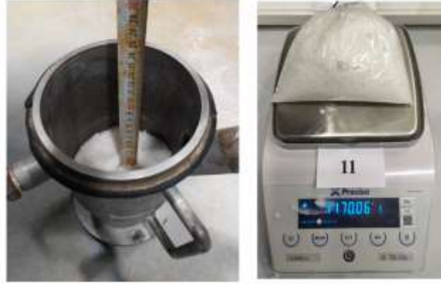
Şekil 3.12. Ürün besleme haznesi ve 80mm yatak yüksekliğindeki tuz ürünü
