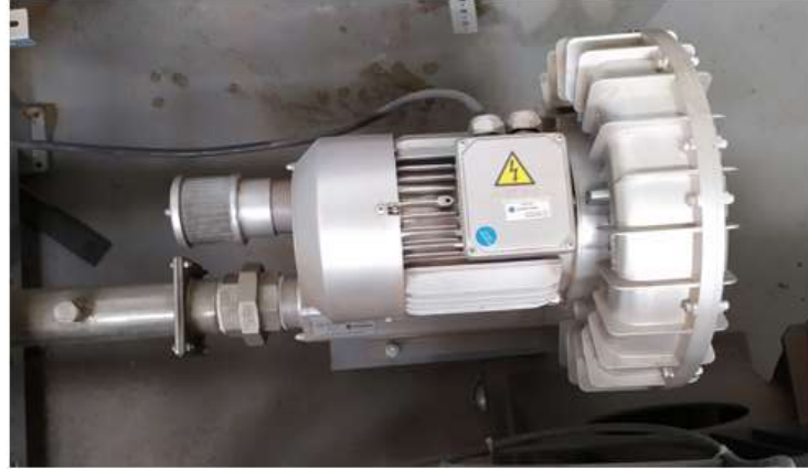
Şekil 3.7. TMM marka EJ 9 KB model kurutucu besleme fanı
