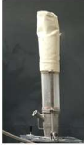
Şekil 3.14. Kurutucu çıkışı iğne keçeli filtre torbası
