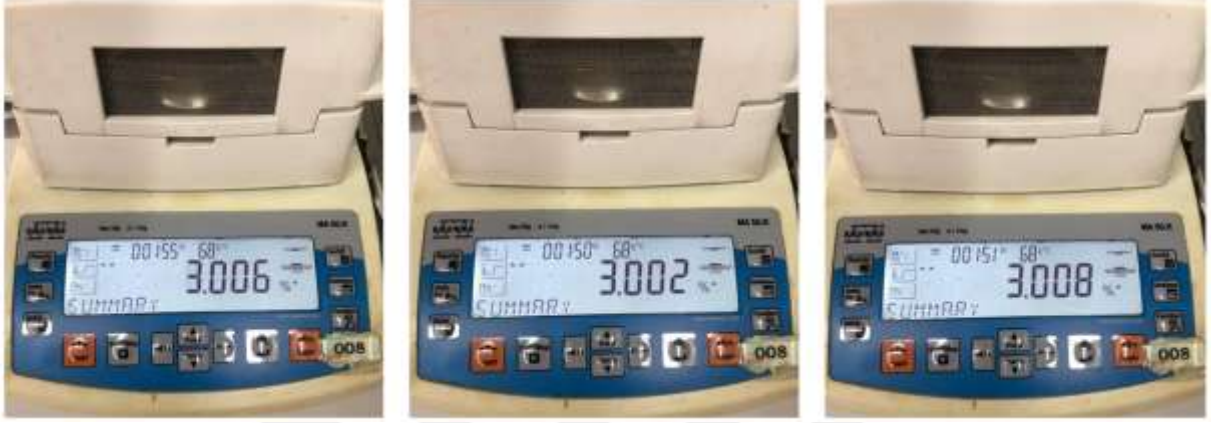
Şekil 4.2. Yaş tuz ürününün nem ölçüm sonuçları
