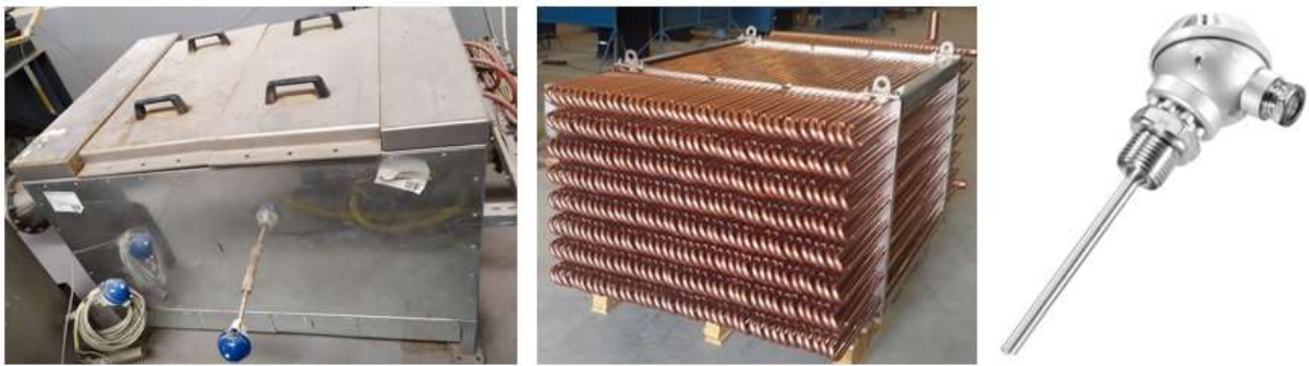
Şekil 3.9. Elektrikli rezistanslı ısıtıcı ve PT100 sıcaklık sensörü
