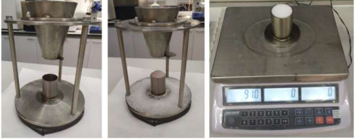
Şekil 3.3. Dökme yoğunluk aparatı ve Desis AHC+ tartım terazisi
