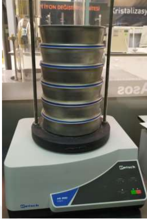
Şekil 3.4. Retsch As 200 Basic marka elek cihazı
