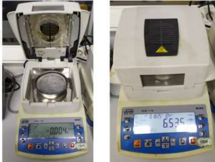
Şekil 3.2. Radwag MA50.R nem tayin cihazı
