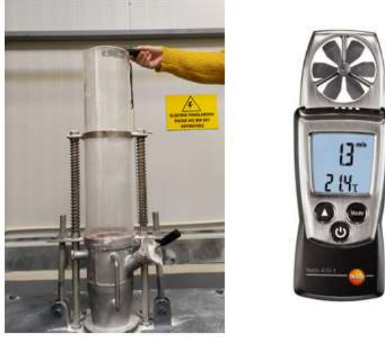
Şekil 3.8. Testo marka 410-1 model Cep Tipi Pervaneli Anemometre
